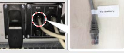
**E** Das andere Ende des zur Batterie führenden Kabels muss an den CAN-Port der Alpha-Batterie angeschlossen werden.
