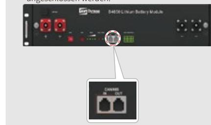
**G** Nachdem alle Verbindungen hergestellt und alle Einstellungen vorgenommen wurden, überprüfen Sie unter „PV Master → Param. → BMS-Status“ den Kommunikationsstatus mit der Batterie. „Kommunikation: OK“ sollte angezeigt werden.
