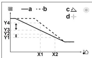
**Korrektur.** Wenn die Korrektur geändert wird, sind die neue bevorzugte Temperatur an X1 und die bevorzugte Temperatur an X2 gleichermaßen höher.
