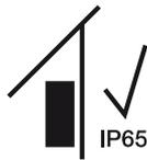
Wechselrichter im geschützten Außenbereich montieren.
