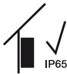
Wechselrichter im Innenbereich montieren.
