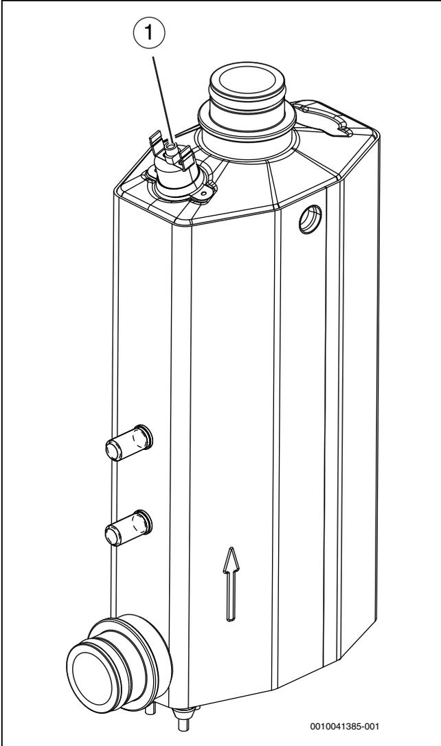
Bild 42 Elektrischer Zuheizer
