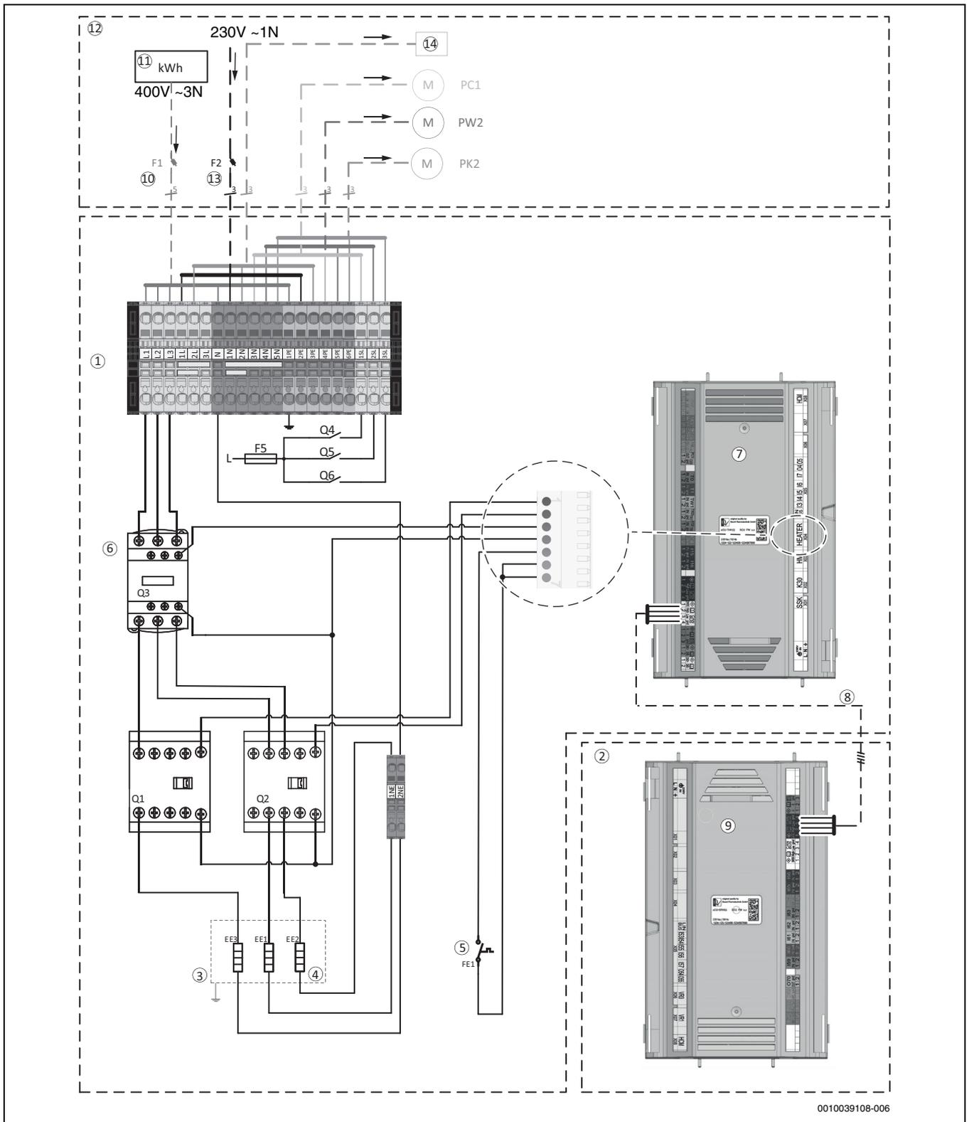
Bild 50 Spannungsversorgung Inneneinheit, EVU-Sperre
