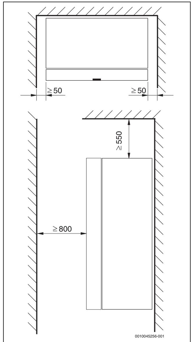
Bild 4 Mindestabstand zu Wänden oder Gegenständen (mm)
