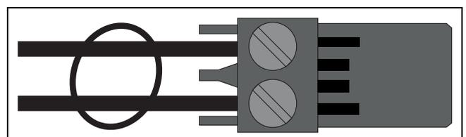
Bild 38 Kabelbinder am Steckverbinder
