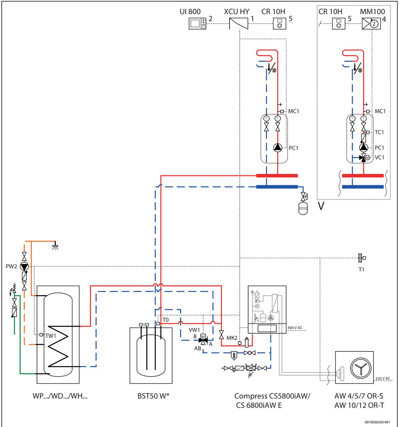
Bild 44 Wärmepumpe mit Inneneinheit, kleinem Pufferspeicher und Warmwasserbereiter
