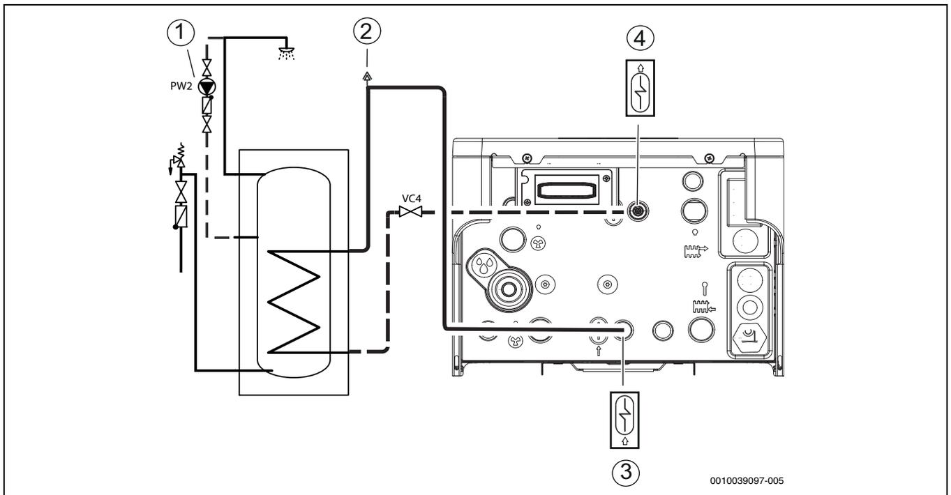
**Bild 21 Trinkwasseranschlüsse Inneneinheit**
