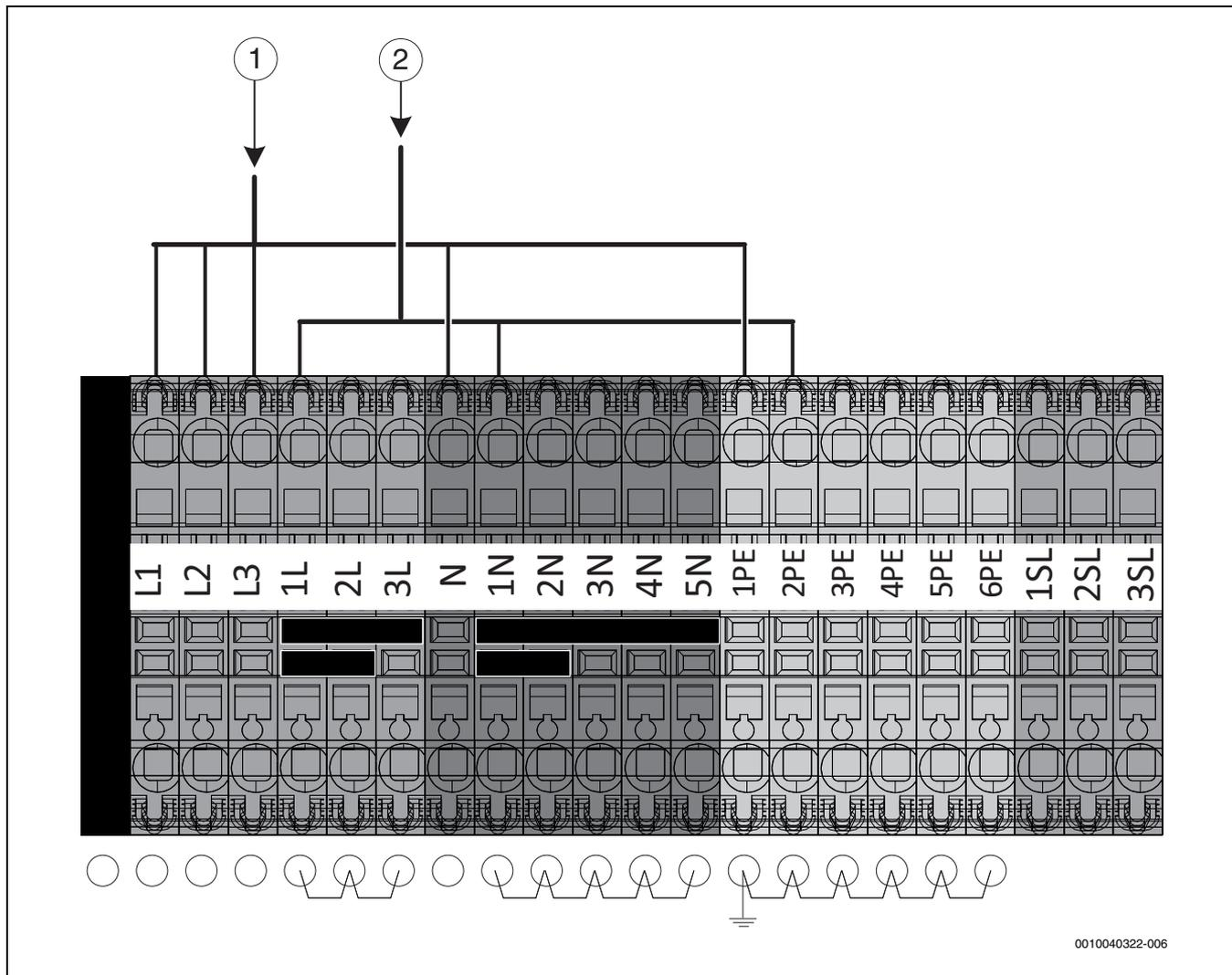
Bild 35 Elektrische Anschlüsse mit EVU-Sperre
