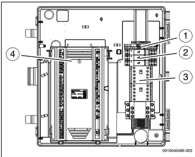
Bild 31 Anordnung der Bauteile im Klemmenkasten
