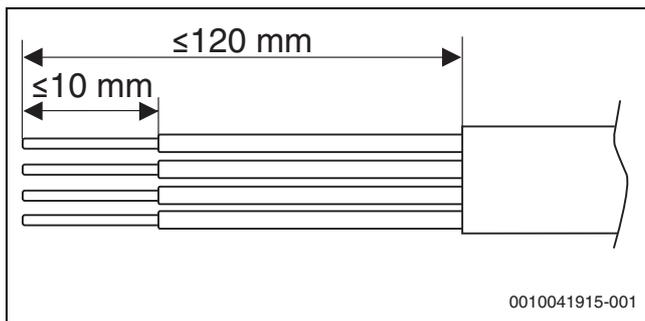
Bild 24 Abisolierung CAN-BUS
