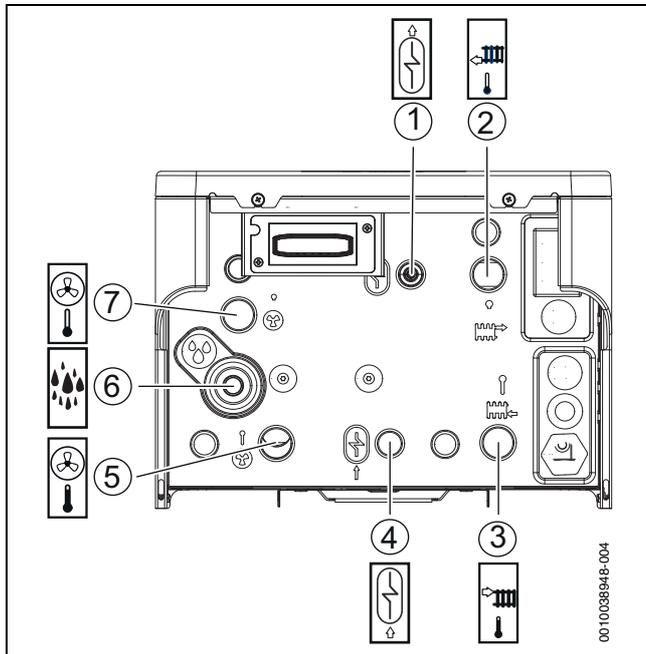
Bild 6 Rohranschlüsse
