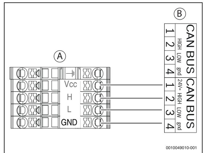
Bild 23 CAN-BUS Wärmepumpe - Inneneinheit
