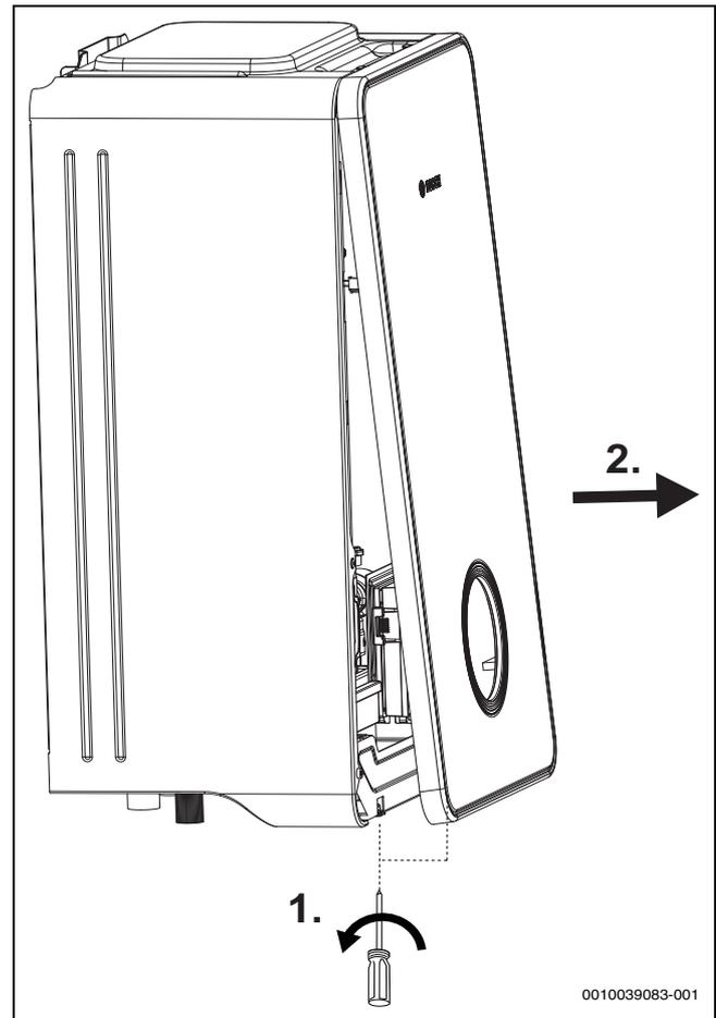
Bild 13 Frontplatten abnehmen
