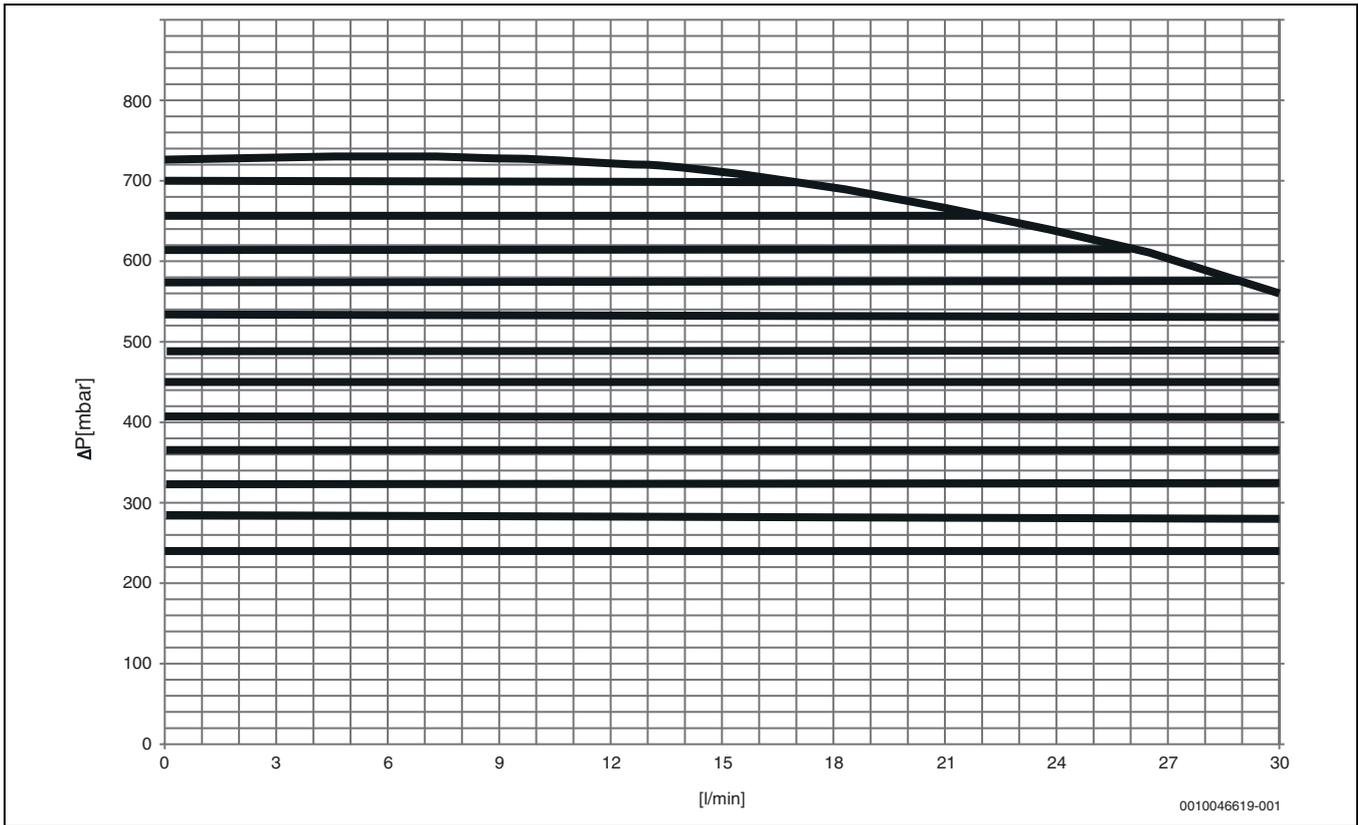
Bild 47 Leistungsdiagramm für Pumpe PC0
