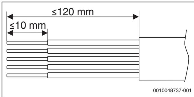
Bild 27 Abisolieren der Adern für den Netzanschluss
