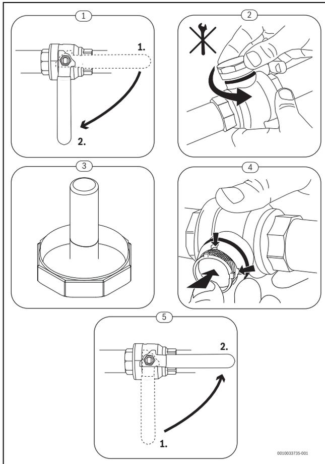
Bild 43 Siebreinigung
