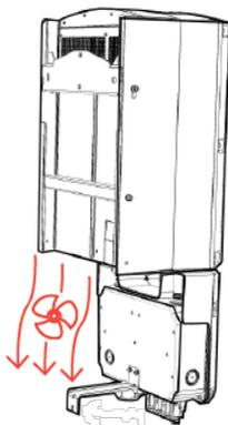
Figure 10: Inverter fan - air flow
