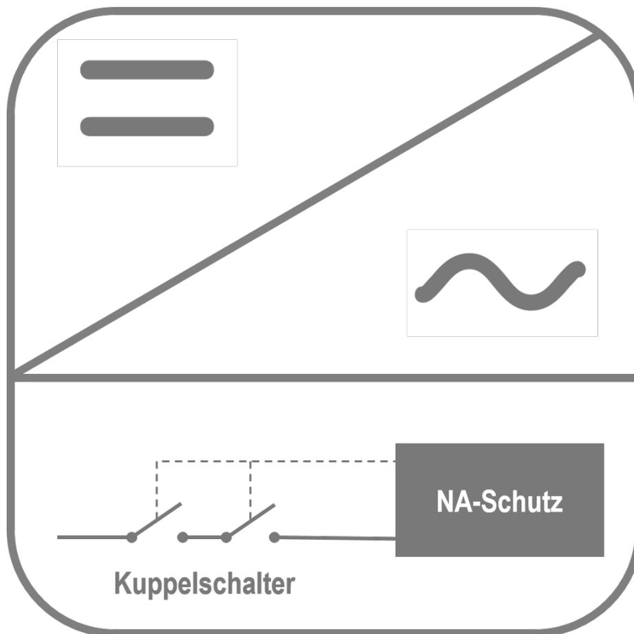
Abbildung 1: Wechselrichterintegrierter NA-Schutz bei Anlagen bis 30 kVA
