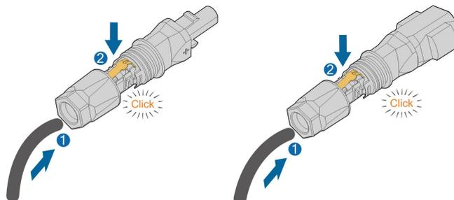
**Schritt 4** Schieben Sie den Einsatz in die Hülse und ziehen Sie die Kabelverschraubung fest (- Drehmoment  $2 \text{ N} \cdot \text{m}$ ).
