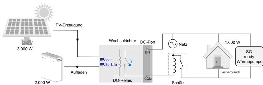
Abbildung 8-24 DO-Betrieb im intelligenten Modus
