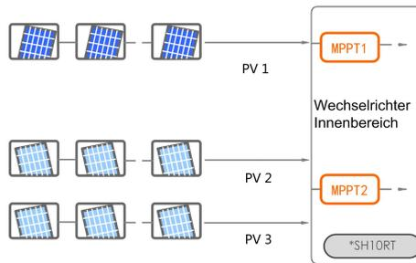
Wenn bei SH10RT zwei PV-Stränge extern parallel geschaltet sind, können die parallel geschalteten Stränge nur mit PV2 oder PV3 verbunden werden. Die anderen Stränge können desweilen nicht zum Verbinden weiterer PV-Stränge verwendet werden.
