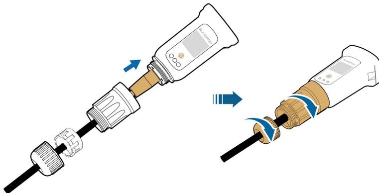
**Schritt 6** Entfernen Sie die wasserdichte Kappe von der Klemme **WLAN** und installieren Sie WiNet-S.
