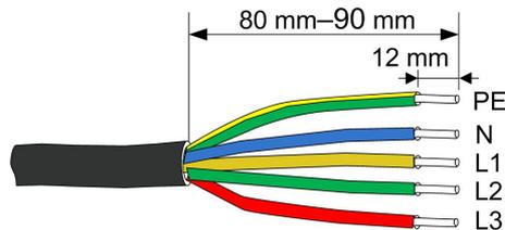
**Schritt 5** Wird ein Litzenkabel verwendet, müssen die beiliegenden Aderendhülsen aufgecrimpt werden.
