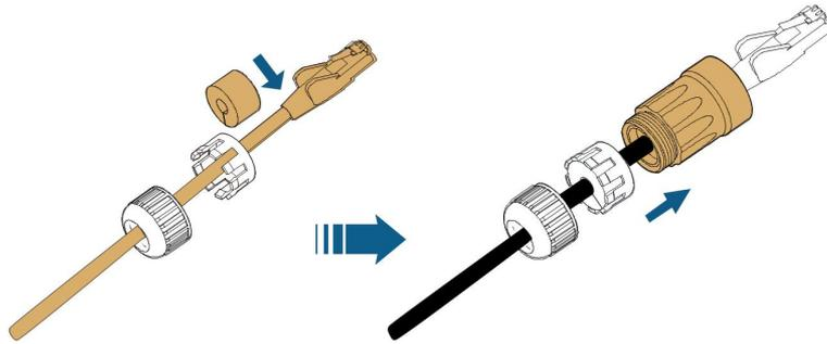
**Schritt 5** Stecken Sie den RJ45-Stecker in den vorderen Steckverbinder, bis ein hörbares Klicken zu hören ist, und ziehen Sie das Gehäuse fest. Setzen Sie die Dichtung ein und befestigen Sie die Überwurfmutter.
