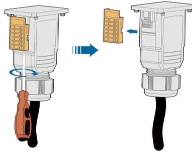
**Schritt 8F** Ühren Sie den Schlitzschraubendreher in eine der beiden Öffnungen ein und drücken Sie diesen mit angemessenem Kraftaufwand, um den Wechselstromstecker zu entfernen.
