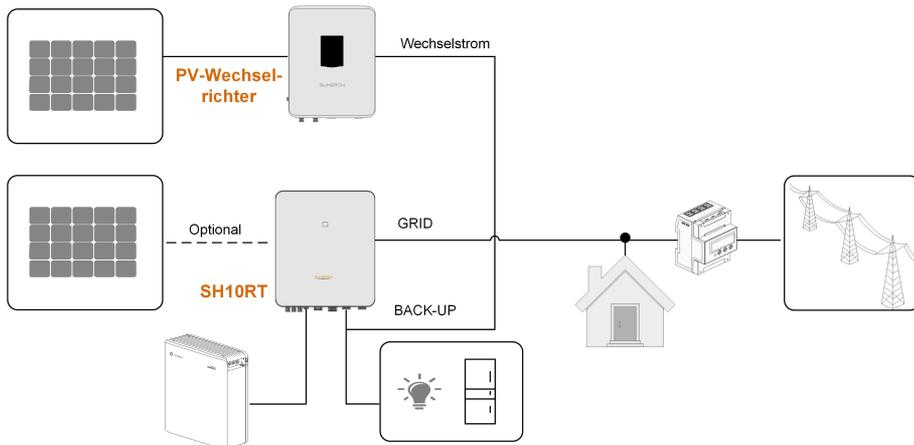
**Abbildung 2-6** Netzunabhängiger Anschluss zur Nachrüstung der bestehenden PV-Anlage
