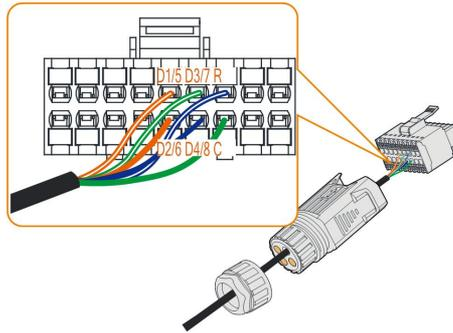
**Schritt 6** Ziehen Sie an den Drähten, um zu überprüfen, ob sie fest installiert sind.
