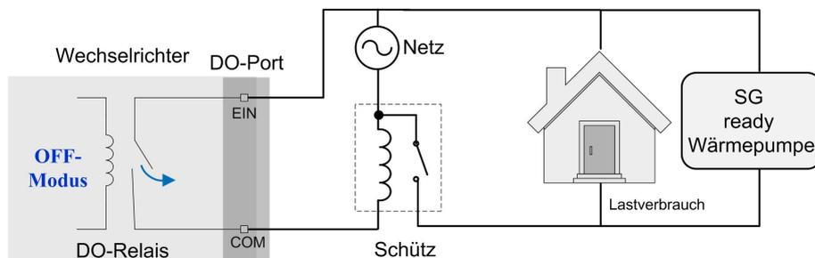
Abbildung 8-23 DO-Betrieb im Schalter-Modus
