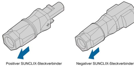
**Schritt 3** Führen Sie das abisolierte Kabel bis zum Anschlag in die Kabelverschraubung ein. Der Litzendraht ist in der Feder zu sehen. Drücken Sie die Feder nach unten, bis sie hörbar einrastet.
