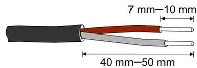
**Schritt 5** Stecken Sie die Drähte in die **RS485**-Klemme gemäß der Kennzeichnung auf der Unterseite des Wechselrichters.
