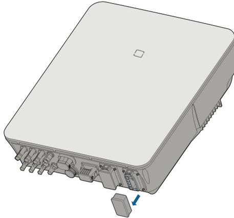
**Schritt 3** Stecken Sie den Netzstecker in die **GRID**-Anschluss an der Unterseite des Wechselrichters, bis ein akustisches Geräusch (Klicken) zu hören ist.
