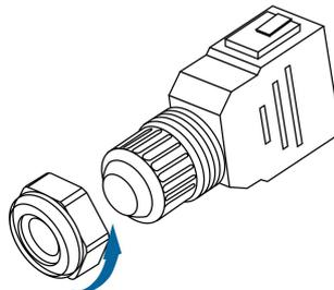
**Schritt 2 (Optional)** Entfernen Sie die innere Gummidichtung, wenn der äußere Durchmesser eines AC-Kabels 19 mm ~ 25 mm beträgt.
