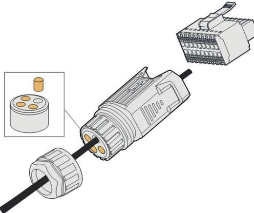
**Schritt 4** Entfernen Sie den Kabelmantel um 7 - 10 mm.
