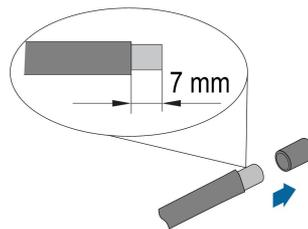
**Schritt 2** Montieren Sie die Crimpkontakte mit einer Crimpzange.
