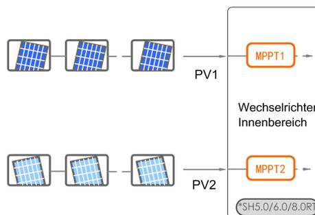
Beim SH10RT entspricht jedes Paar PV-Anschlüsse einem unabhängigen PV-Strang. PV-Eingang PV1 an MPPT1 und PV2 anschließen, PV3 an MPPT2 anschließen. Für eine optimale Nutzung der Gleichstromversorgung sollten PV2 und PV3 in der PV-Strang-Struktur identisch sein, einschließlich Typ, Anzahl, Neigung und Ausrichtung der PV-Module.
