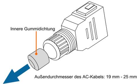
**Schritt 3** Fädeln Sie das AC-Kabel in einer angemessenen Länge in das Stecker-Gehäuse und die Verschraubung ein.
