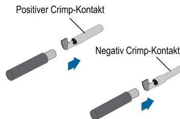
**Schritt 3** Führen Sie das Kabel durch die Kabelverschraubung. Setzen Sie den Crimpkontakt in den Isolator ein, bis er einrastet. Ziehen Sie das Kabel vorsichtig zu sich, um eine feste Verbindung zu gewährleisten. Ziehen Sie die Kabelverschraubung und den Isolator fest (Drehmoment 2,5 N•m bis 3 N•m).
