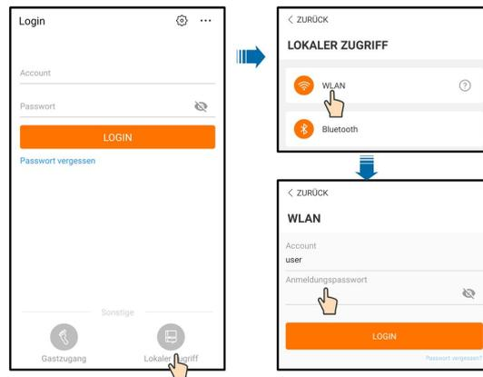
Abbildung 8-2 Direkte WLAN Verbindung
