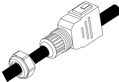
**Schritt 4** Entfernen Sie den Kabelmantel um 80~90 mm und entfernen Sie die Aderisolation um 12 mm.
