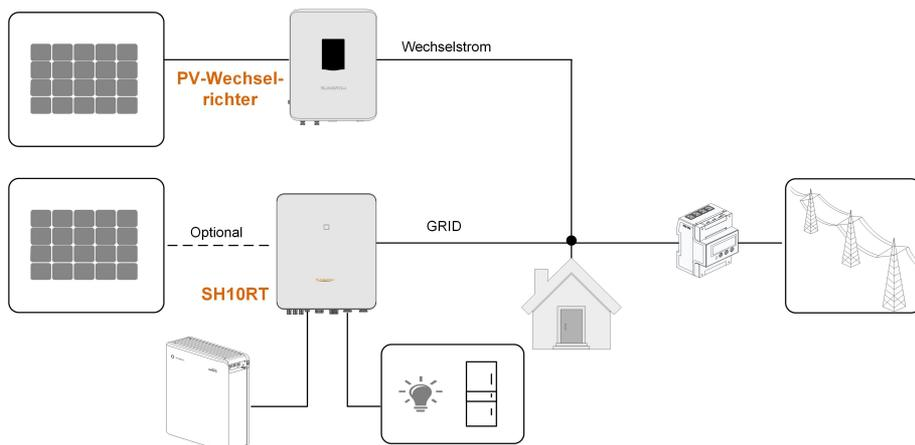
Abbildung 2-5 Netzgekoppelter Anschluss zur Nachrüstung der bestehenden PV-Anlage
