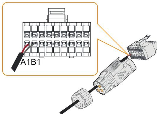
**Schritt 6** Ziehen Sie entsprechend an den Drähten, um zu überprüfen, ob sie fest installiert sind.
