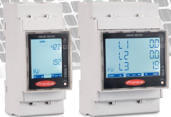
Der Fronius Smart Meter TS ist ein bidirektionaler Zähler zur Optimierung des Eigenverbrauchs, zur Erfassung der Lastkurve und zur Steuerung der verschiedenen Energieflüsse. Dank hoher Messgenauigkeit und schneller Kommunikation über die Schnittstelle Modbus RTU wird bei Einspeisebegrenzungen eine schnellere und genauere dynamische Einspeiseregulierung als bei S0-Zählern ermöglicht.
