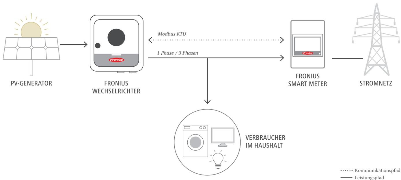
Der Fronius Smart Meter ist mit allen Wechselrichtern mit RS485-Schnittstelle (Modbus RTU) kompatibel. In bereits installierten Wechselrichtern ohne Schnittstelle kann der Fronius Smart Meter in Kombination mit dem Fronius Datamanager 2.0 jederzeit nachgerüstet werden.
