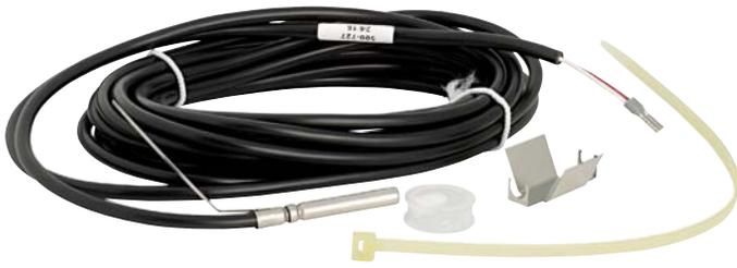
PT 1000 Fühler mit einer Kabellänge von 5 m und einem Durchmesser von 6 mm zur Verwendung als Tauchfühler oder Anlegefühler in Wärmepumpenanlagen.
