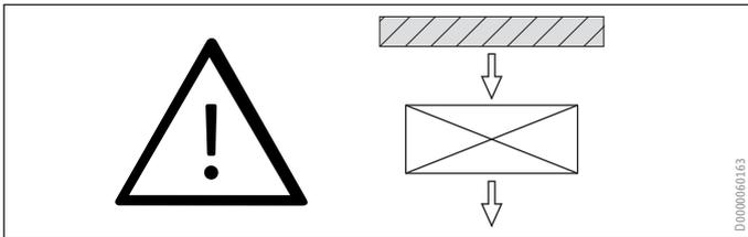
Das Gerät ist für die Aufstellung vor einer Wand konzipiert. Beachten Sie die Mindestabstände. Falls das Gerät im Freifeld oder auf einem Dach aufgestellt wird, muss auf der Ansaugseite der Lufteintritt geschützt werden. Errichten Sie in diesem Fall eine Schutzwand gegen den Wind.
