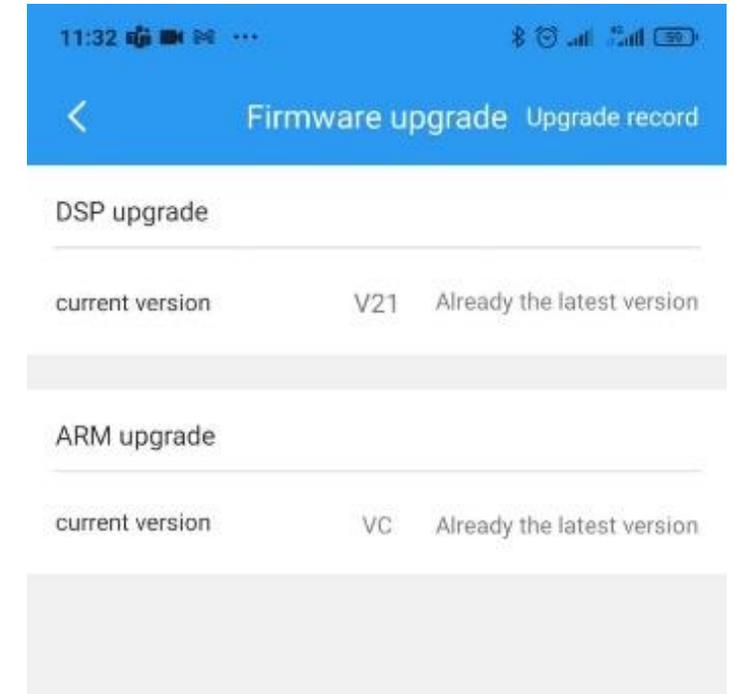
Der angezeigte Progress ist lediglich der Download der Firmware Datei. Nach der Erfolgsmeldung in der Inbetriebnahme App dauert es 5 bis 10 Minuten bis das Update vollendet ist und das Gerät Neustartet. Danach haben sie wieder zugriff auf die Einstellungen und können den neuen Firmware Stand kontrollieren.
