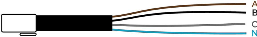
Für Standorte mit einphasigem Netzanschluss wird der Kabelbaum für die Spannungsabgriffe modifiziert, indem die schwarzen, grauen und braunen Leitungen unter Verwendung eines Wago-Verbinders kombiniert werden (siehe **Anmerkung 1** in [Neurio W2 Zähler im Schaltschrank installiert, Messung von zwei Leitern mittels CT Y-Splitter auf Seite 63](#) zur Veranschaulichung). In einphasigen elektrischen Systemen werden nur die braune und blaue Leitung benötigt.
