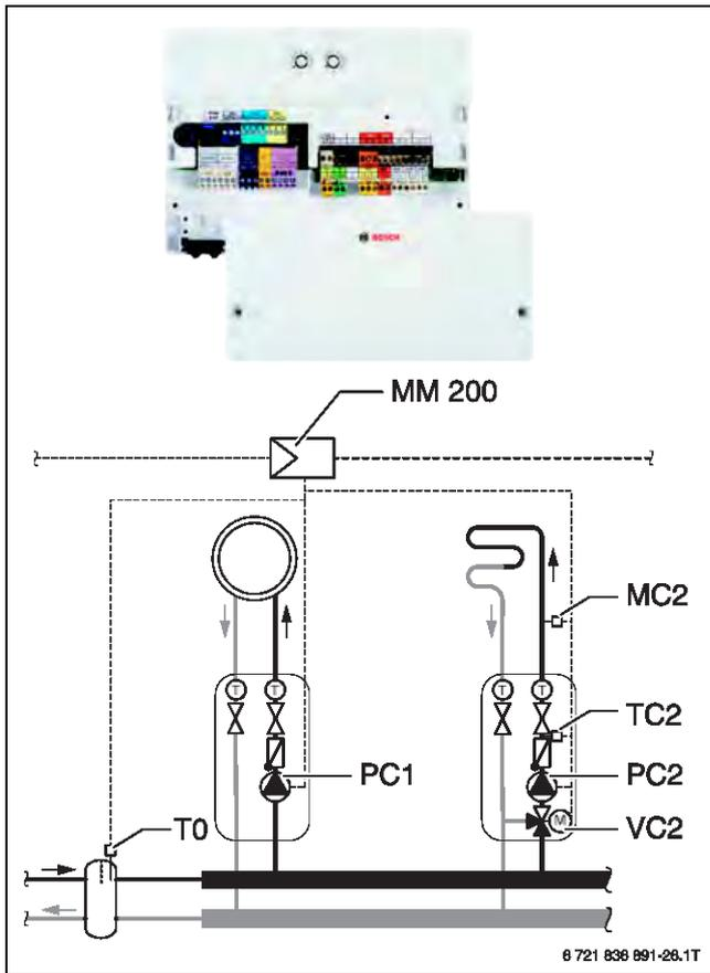
Bild 170 Heizkreismodul MM 200
