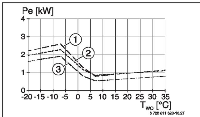
Bild 88 Leistungsaufnahme CS7001iAW 7 OR...-S/CS7400iAW 7 OR...-S/CS7000iAW 7 IR...-S
