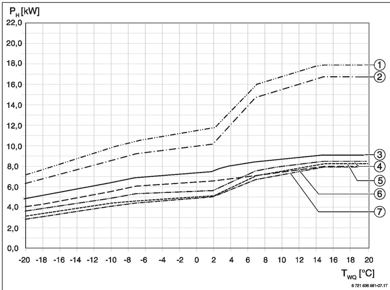
Bild 31 Heizleistungskurven der Wärmepumpen CS7001iAW/CS7400iAW (55 °C Vorlauftemperatur, 100 % Modulation)
