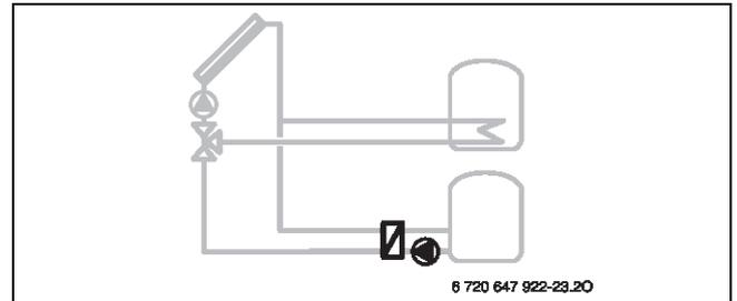
Bild 184 **Ext. Wärmetauscher Sp.2(F)**
