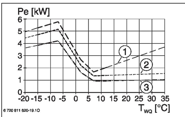
Bild 100 Leistungsaufnahme CS7001iAW 17 OR...-T/CS7000iAW 17 IR...-T
