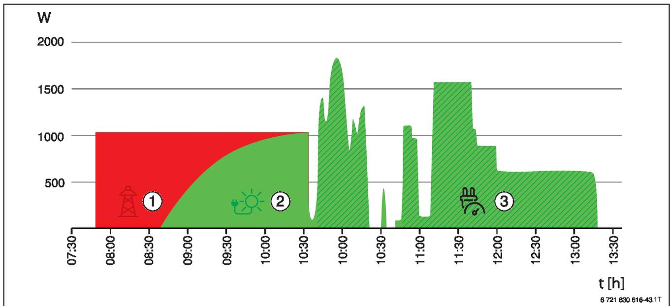
Bild 131 CS700iAW 7 ORE-S, Leistungsaufnahme ca. 500 ... 2000 W [35 °C] und leistungsgeregelt durch den Energiemanager von Bosch
