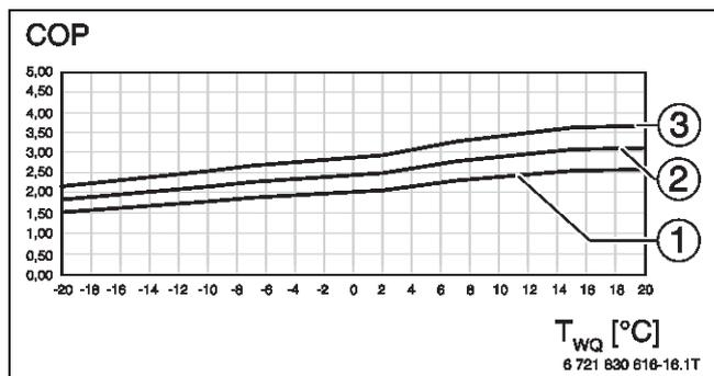
Bild 87 Leistungszahl CS7000iAW 7 IR...-S (100 % Modulation)
