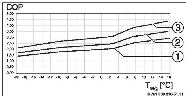
Bild 83 Leistungszahl CS7400iAW 5 OR...-S (100 % Modulation)
