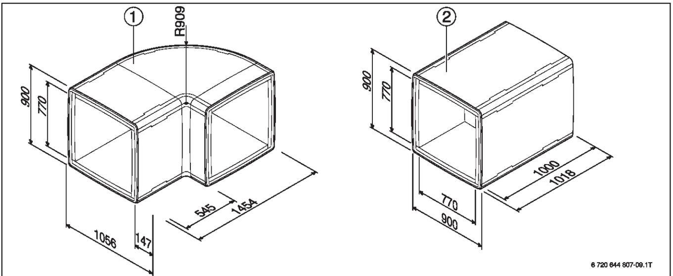
Bild 41 Luftkanäle des Systems Luftkanal 900 (Maße in mm)
