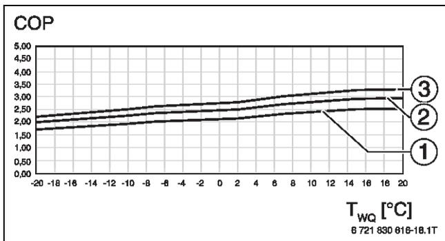
Bild 91 Leistungszahl CS7000iAW 9 IR...-S (100 % Modulation)
