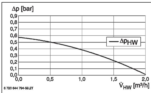
Bild 89 Restförderdruck CS7001iAW 7 OR...-S/CS7400iAW 7 OR...-S/CS7000iAW 7 IR...-S
