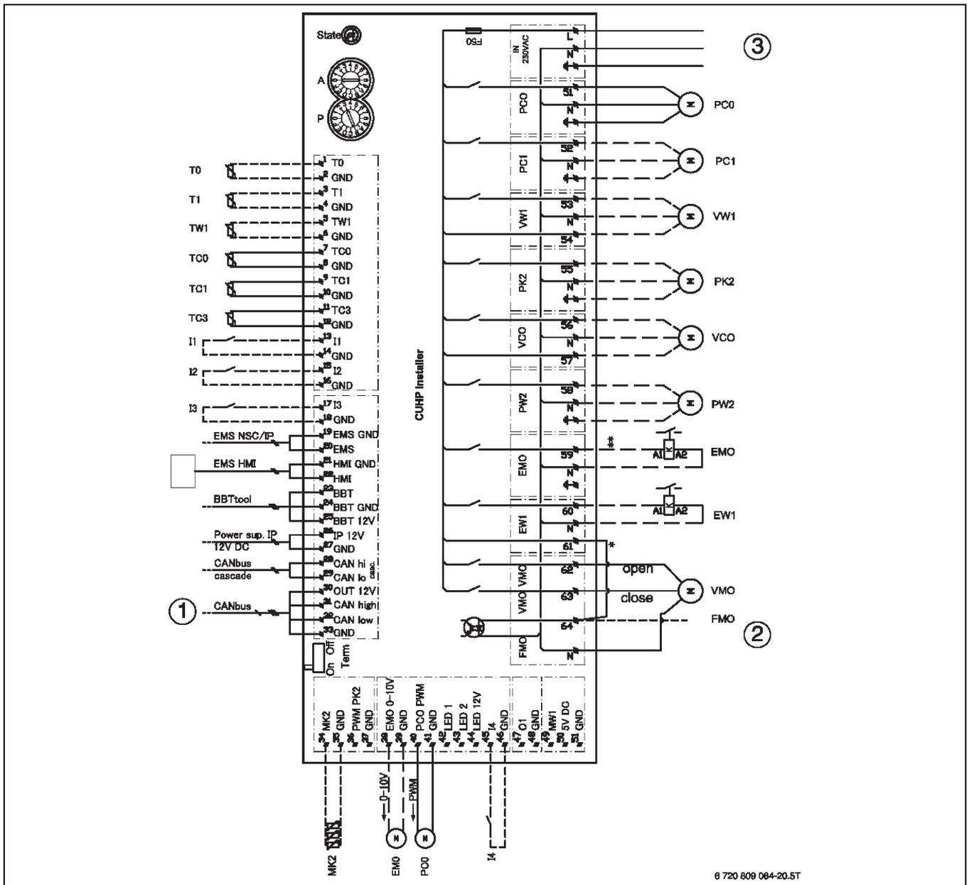
Bild 158 Schaltplan Installationsmodul
