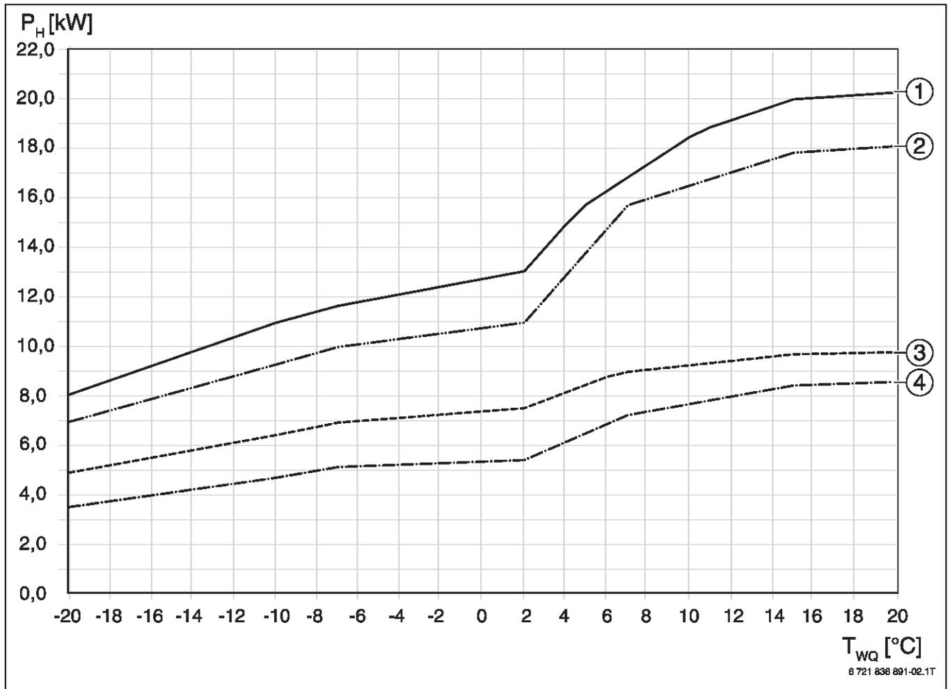
Bild 33 Heizleistungskurven der Wärmepumpen CS7000iAW (45 °C Vorlauftemperatur, 100 % Modulation)
