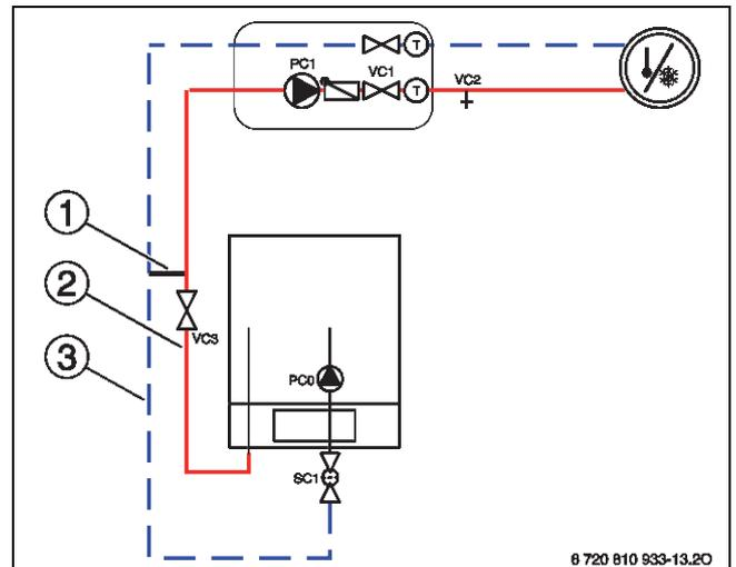
Bild 238 Inneneinheit mit Heizkreis und Bypass
