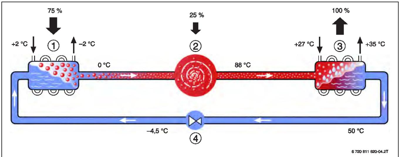
Bild 4 Schematische Darstellung des Kältemittelkreises in einer Wärmepumpenanlage (Beispiel)
