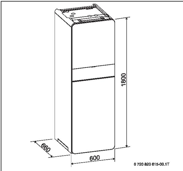
Bild 115 Abmessungen der Inneneinheit AWM 9/17, AWMS 9/17
