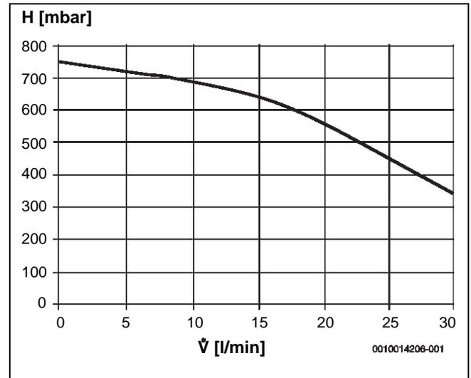
Bild 215 Restförderdruck Primärseite
