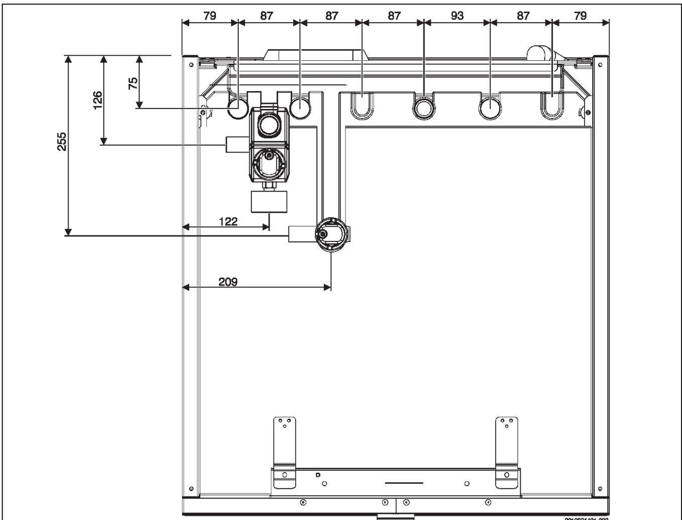
Bild 124 Abmessungen – Draufsicht
