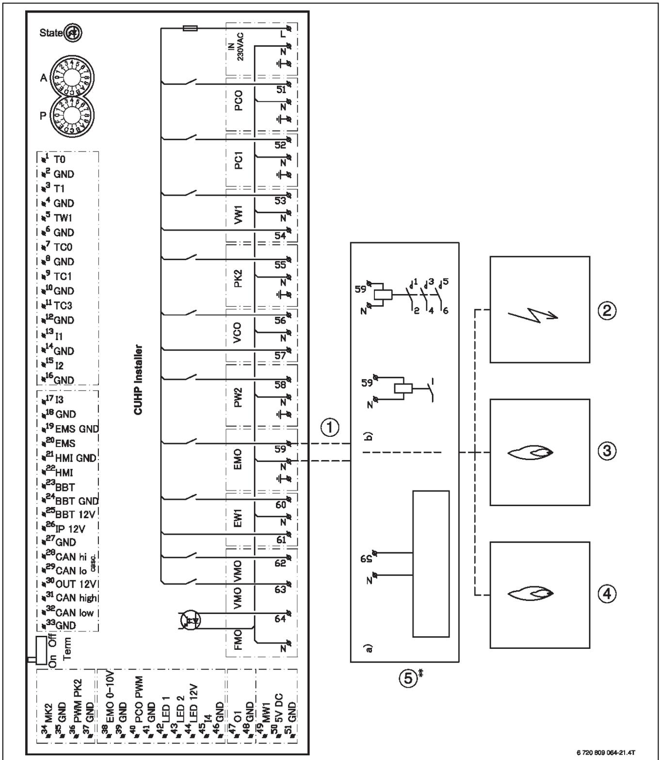
Bild 166 Schaltplan Installationsmodul, Start/Stop
