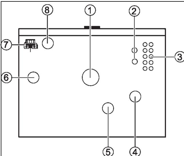
Bild 105 Rohranschlüsse der Inneneinheit AWE (Ansicht von unten)
