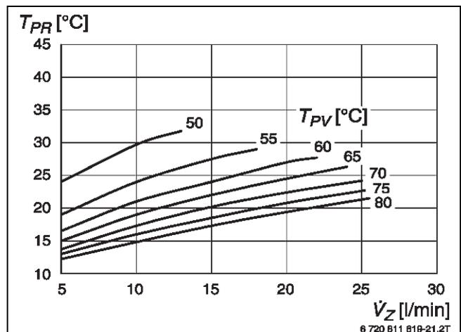
Bild 220 Volumenstrom zum Pufferspeicher (Rücklauf) bei 45 °C Zapftemperatur
