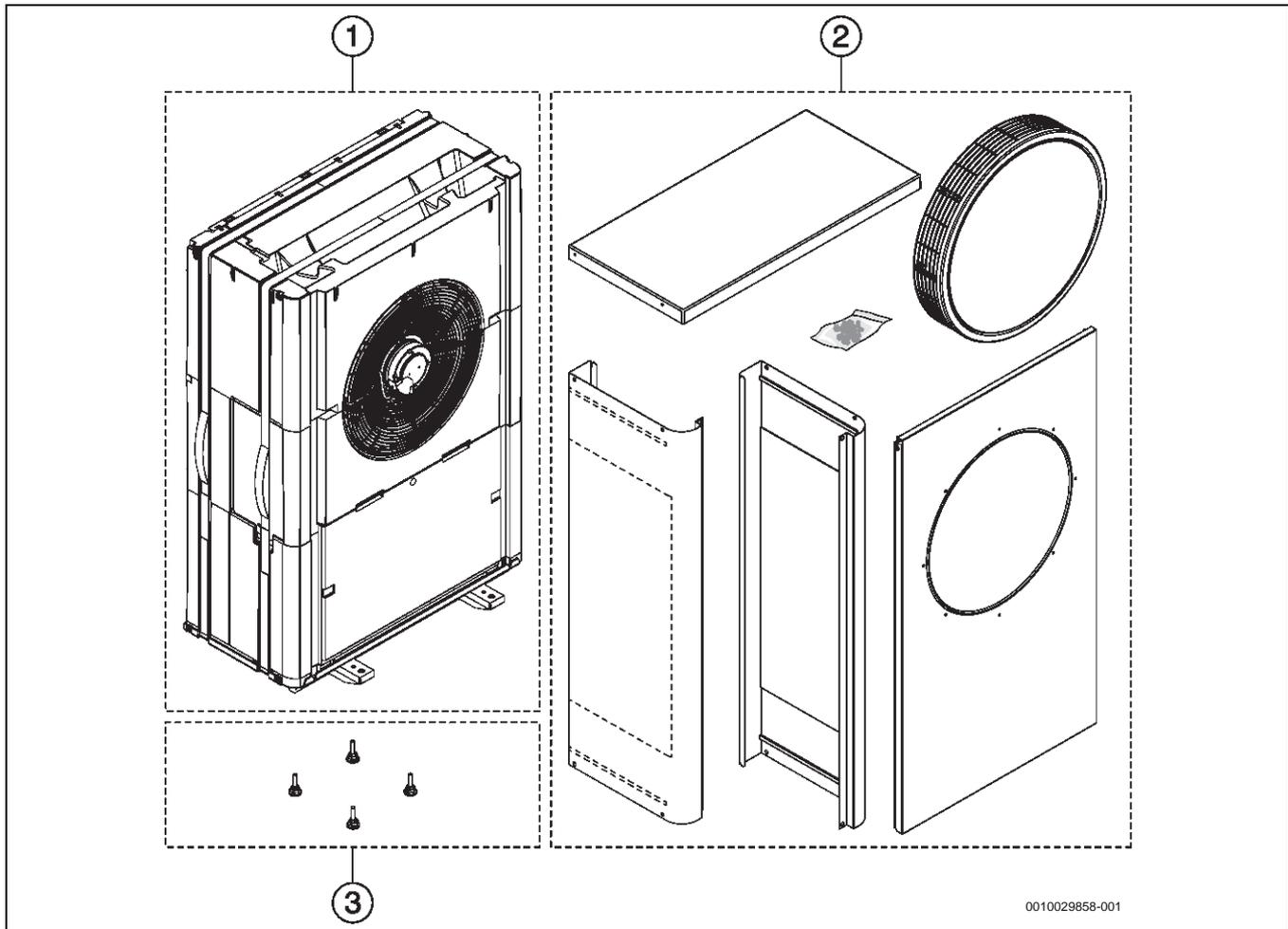
Bild 72 Lieferumfang Außeneinheit CS7400iAW 5 OR...-S und CS7400iAW 7 OR...-S
