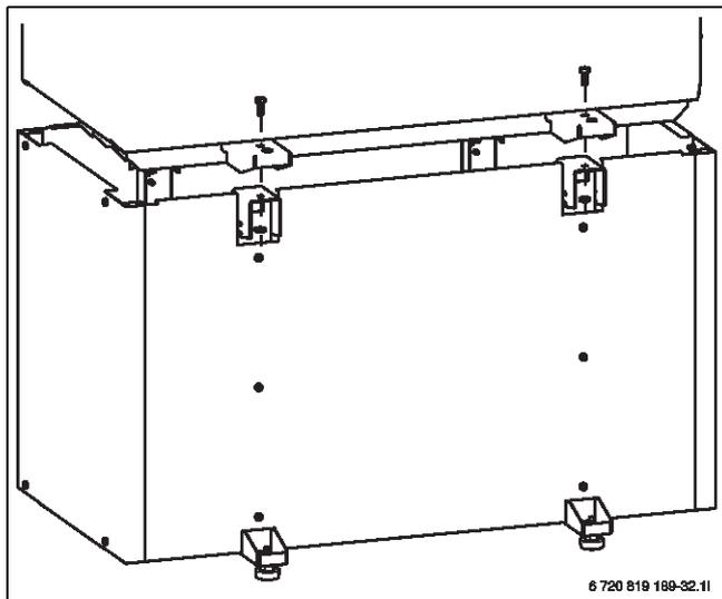
Bild 37 Wärmepumpe auf Gestell montieren
