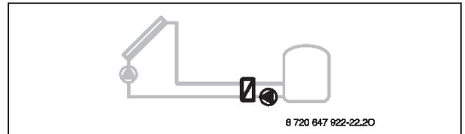
Bild 183 **Ext. Wärmetauscher Sp. 1(E)**
