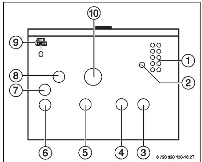
Bild 107 Rohranschlüsse der Inneneinheit AWB (Ansicht von unten)
