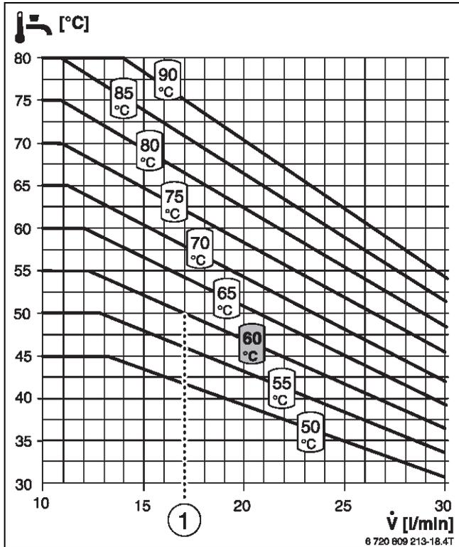
Bild 217 Temperaturverhalten Frischwasserstation FF 20
