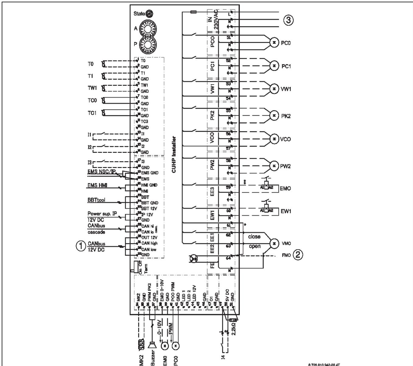
Bild 165 Schaltplan Installationsmodul
