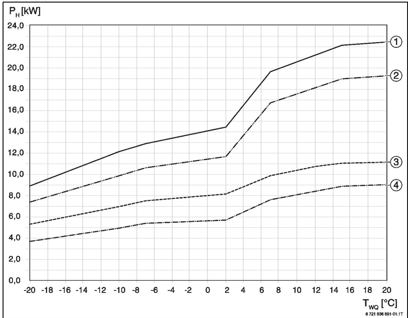
Bild 32 Heizleistungskurven der Wärmepumpen CS7000iAW (35 °C Vorlauftemperatur, 100 % Modulation)
