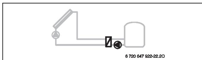
Bild 174 **Ext. Wärmetauscher Sp. 1(E)**
