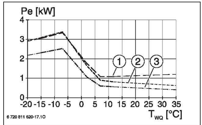
Bild 92 Leistungsaufnahme CS7001iAW 9 OR...-S/CS7000iAW 9 IR...-S
