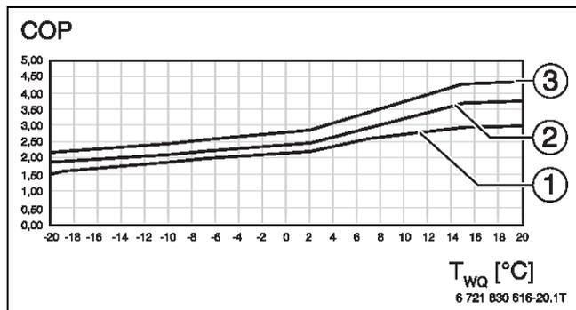
Bild 95 Leistungszahl CS7000iAW 13 IR...-T (100 % Modulation)
