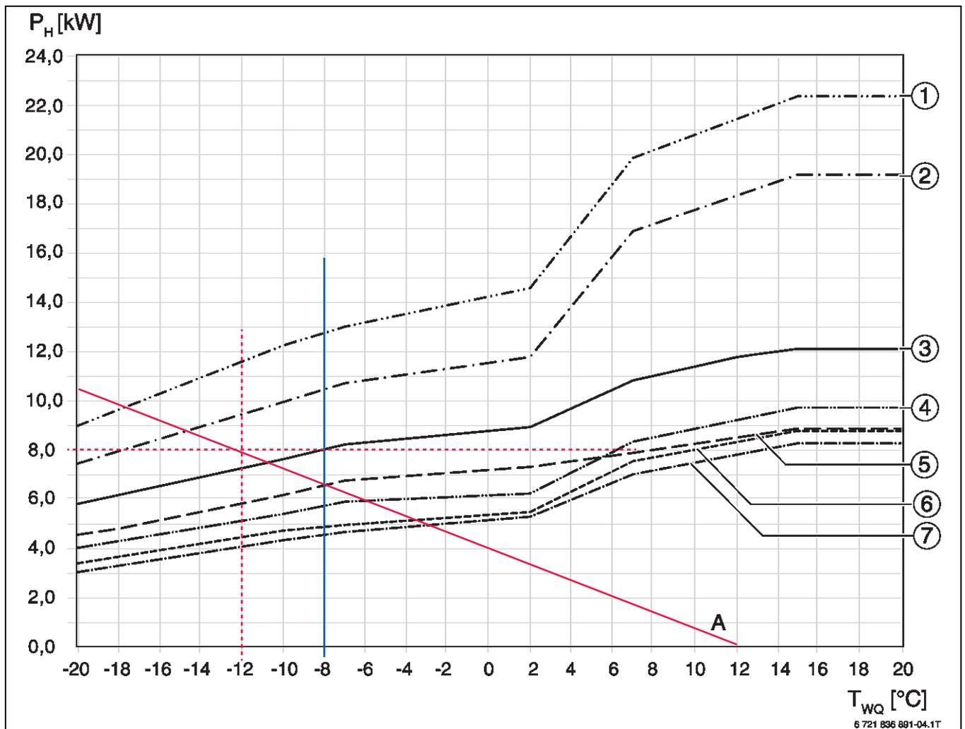
Bild 28 Beispiel für Heizleistungskurven der Wärmepumpen CS7001iAW/CS7400iAW (35 °C Vorlauftemperatur, 100 % Modulation) mit Beispiel
