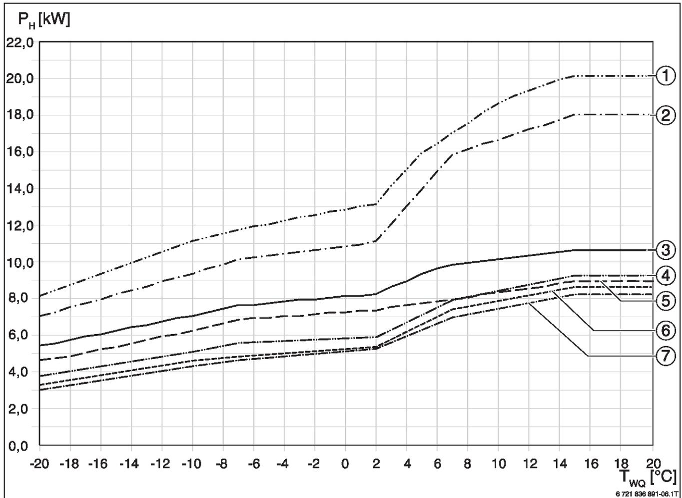
Bild 30 Heizleistungskurven der Wärmepumpen CS700iAW/CS7400iAW (45 °C Vorlauftemperatur, 100 % Modulation)
