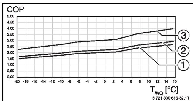
Bild 86 Leistungszahl CS7400iAW 7 OR...-S (100 % Modulation)
