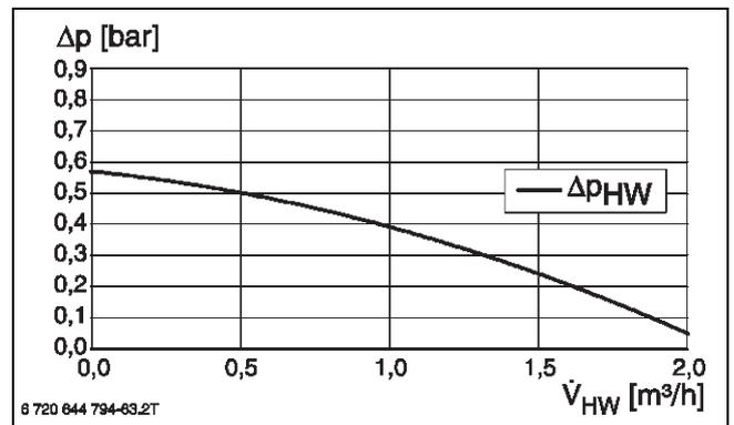
Bild 93 Restförderdruck CS7001iAW 9 OR...-S/CS7000iAW 9 IR...-S
