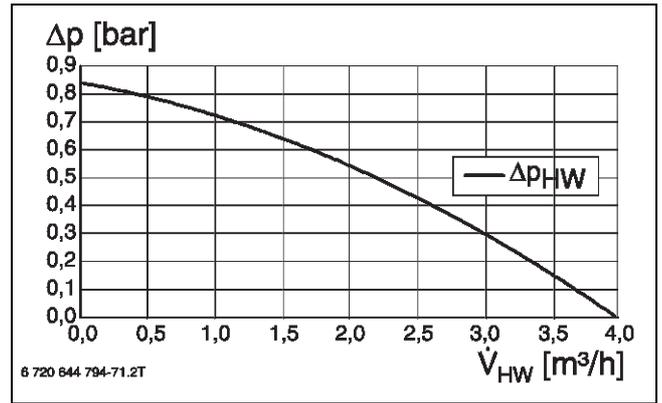
Bild 101 Restförderdruck CS7001iAW 17 OR...-T/CS7000iAW 17 IR...-T
