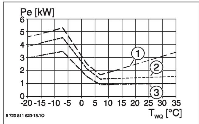
Bild 96 Leistungsaufnahme CS7001iAW 13 OR...-T/CS7000iAW 13 IR...-T
