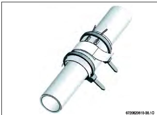
Bild 27 Montage des Taupunktfühlers (Beispiel)
