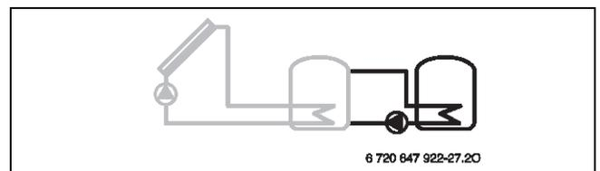
Bild 187 **Umladesystem mit Wärmet.(J)**
