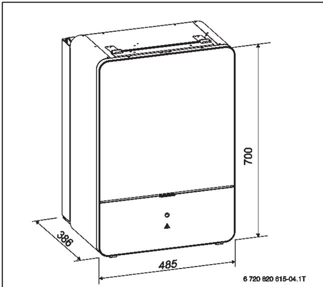
Bild 108 Abmessungen der Inneneinheit AWE 9/17, AWB 9/17
