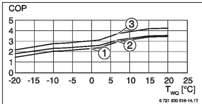
Bild 82 Leistungszahl CS7001iAW 5 OR...-S (100 % Modulation)
