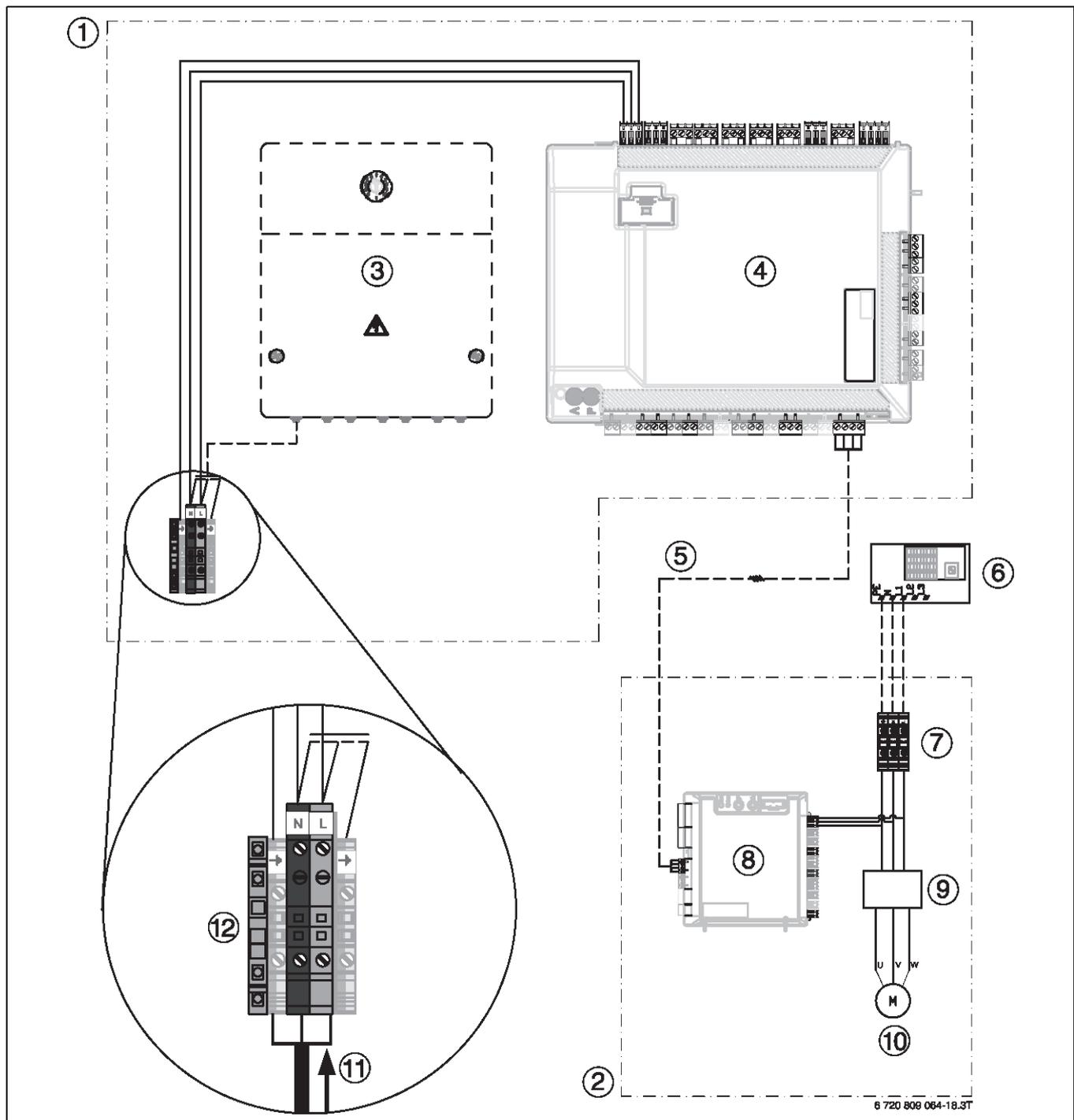
Bild 155 Wärmepumpen-Inneneinheit mit externem Zuheizter – Überblick
