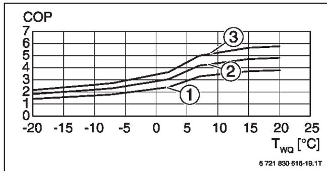
Bild 94 Leistungszahl CS7001iAW 13 OR...-T (100 % Modulation)
