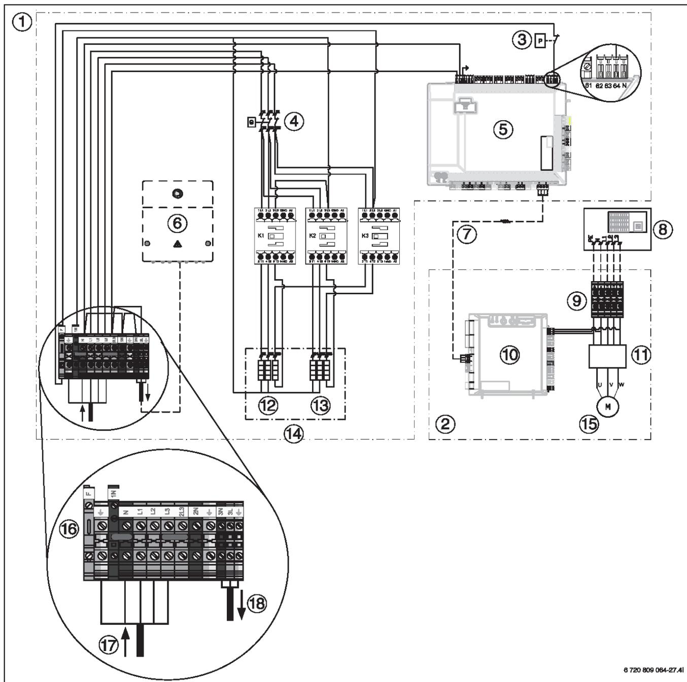
Bild 153 3-phasige Wärmepumpe CS7001iAW 13 OR...-T/CS7000iAW 13 IR...-T/CS7001iAW 17 OR...-T/CS7000iAW 17 IR...-T und 3-phasiger integrierter elektrischer Zuheizler
