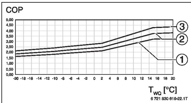
Bild 99 Leistungszahl CS7000iAW 17 IR...-T (100 % Modulation)
