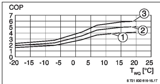
Bild 85 Leistungszahl CS7001iAW 7 OR...-S (100 % Modulation)
