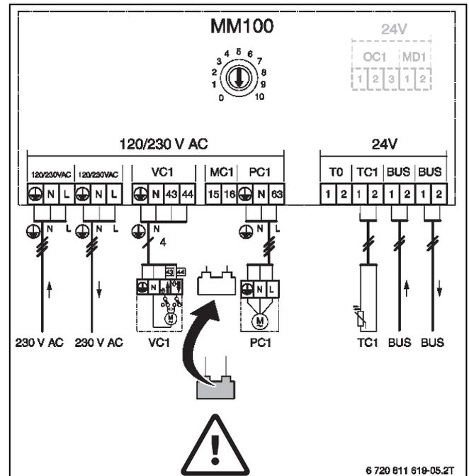
Bild 169 Anschlussplan des Heizkreismoduls MM 100
