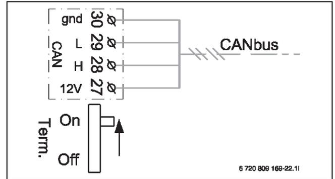
Bild 144 CAN-BUS-Terminierung
