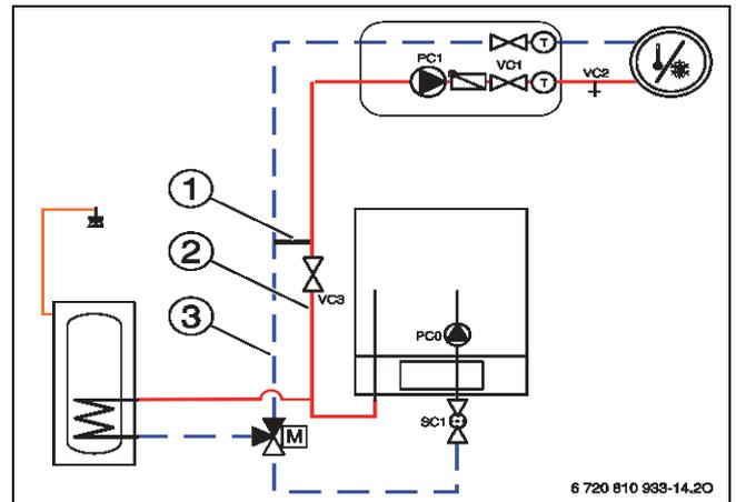
Bild 239 Inneneinheit mit Heizkreis, Warmwasserbereitung und Bypass
