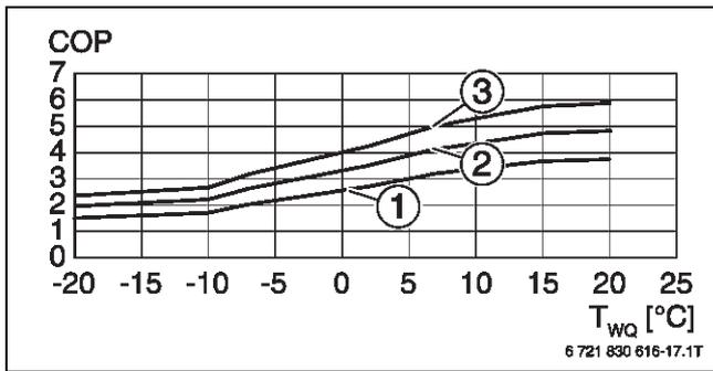
Bild 90 Leistungszahl CS7001iAW 9 OR...-S (100 % Modulation)
