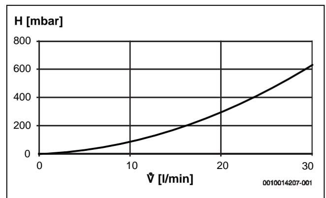
Bild 216 Druckverlust Sekundärseite
