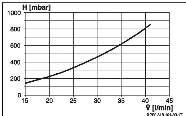
Bild 224 Druckverlust Sekundärseite
