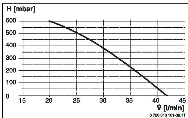
Bild 223 Restförderdruck Primärseite
