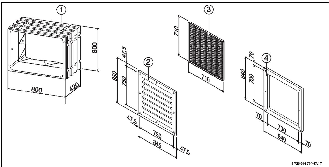
Bild 40 Wanddurchführung, Wetter-/Regenschutzgitter, Maschendrahtgitter und Verblendrahmen des Systems Luftkanal (Maße in mm)
