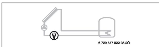
Bild 177 **Wärmemengenzählung(L)**
