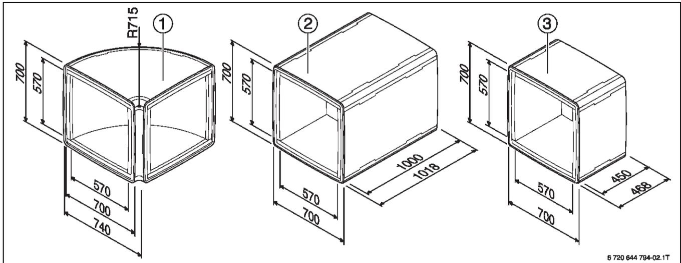
Bild 39 Luftkanäle des Systems Luftkanal 700 (Maße in mm)
