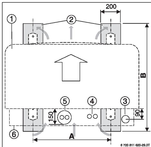
Bild 53 Lage der Fundamente und Rohre (CS700iAW/CS7400iAW)
