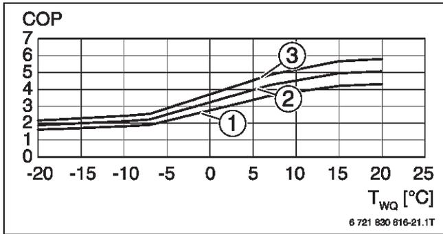
Bild 98 Leistungszahl CS7001iAW 17 OR...-T (100 % Modulation)
