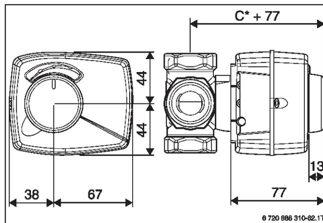
Bild 235 Abmessungen Mischermotor
