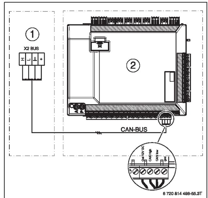
Bild 145 CAN-BUS Verbindung zwischen Wärmepumpeneinheit und Inneneinheit
