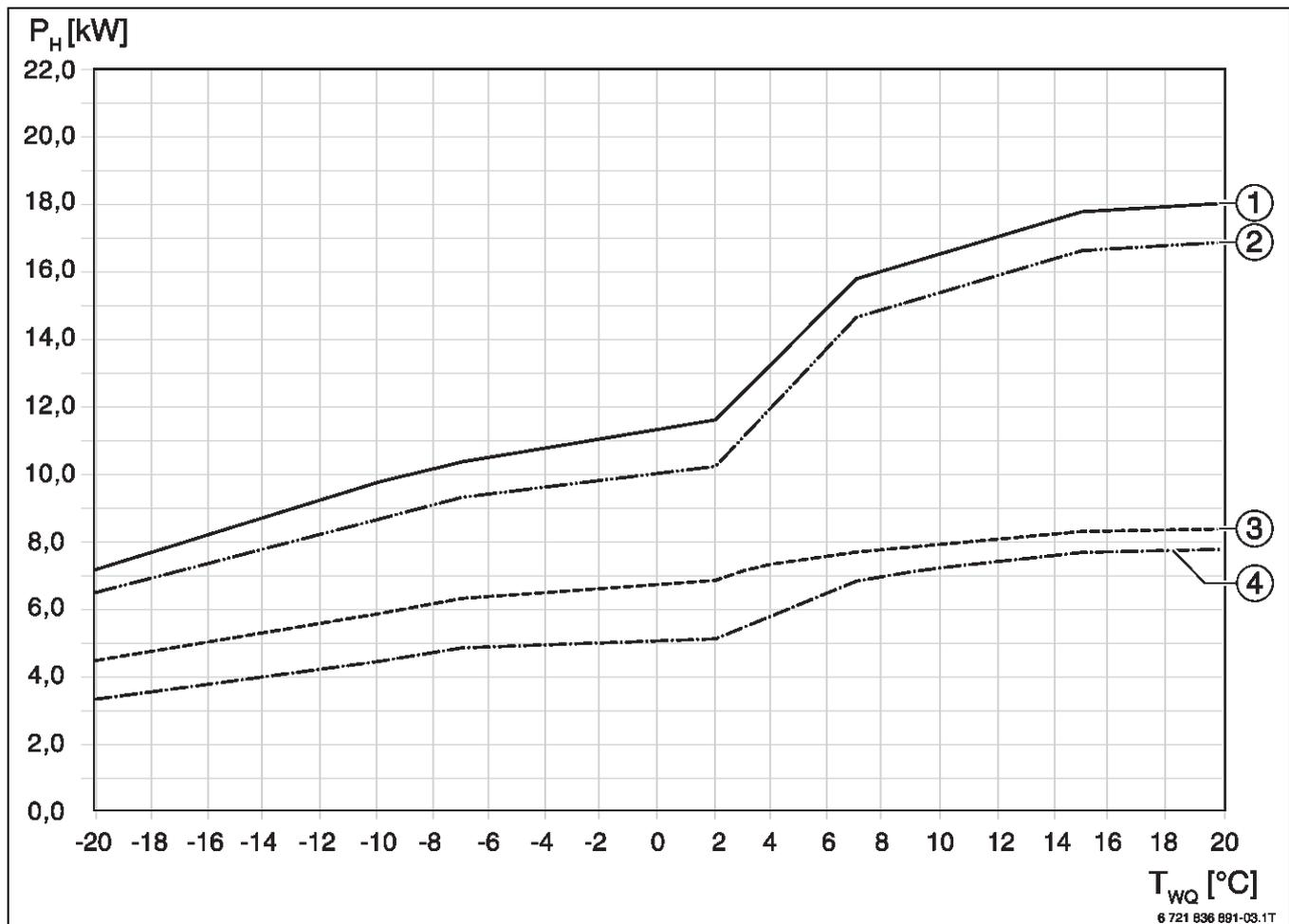
Bild 34 Heizleistungskurven der Wärmepumpen CS7000iAW (55 °C Vorlauftemperatur, 100 % Modulation)
