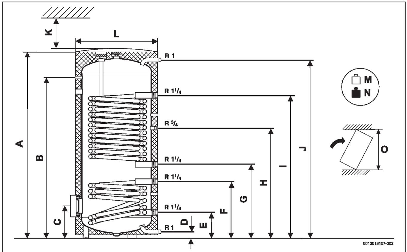
Bild 203 Anschlussmaße und Abmessungen der Solarspeicher WPS 390/490-1 EP
