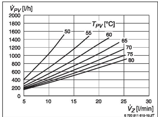
Bild 219 Volumenstrom vom Pufferspeicher (Vorlauf) bei 60 °C Zapftemperatur
