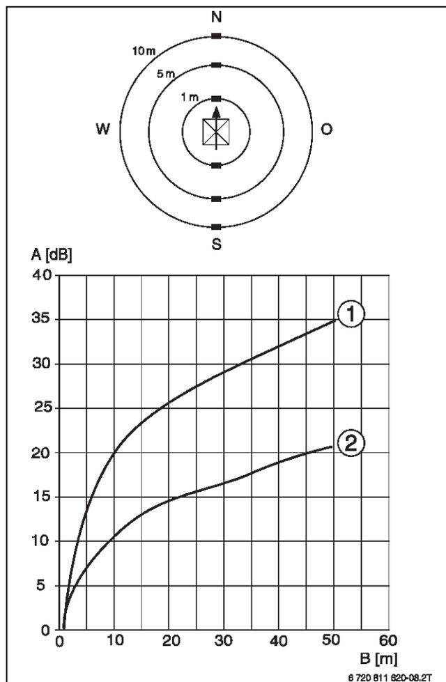
Bild 59 Schalldruckpegel-Abnahme in zunehmendem Abstand zur Wärmepumpe
