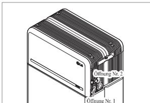
22. Montieren Sie den Adapter oder die Abdeckkappe entsprechend örtlichen Vorschriften. Führen Sie das Ethernet Kabel RMD durch Öffnung Nr. 2 und schließen Sie das Kabel an. Danach fahren Sie fort mit **3.2 Installationsvorgang für die fernbedienbare Überwachungseinrichtung (RMD)**.
