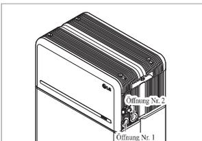
21. Montieren Sie den Adapter oder die Abdeckkappe entsprechend örtlichen Vorschriften. Führen Sie das Ethernet Kabel RMD durch Öffnung Nr. 2 und schließen Sie das Kabel an. Danach fahren Sie fort mit **3.2 Installationsvorgang für die fernbedienbare Überwachungseinrichtung (RMD)**.
