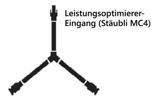
PV-Modul "+" und "-" (identisch mit Modul-Steckverbindern)
