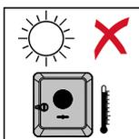
Um die Erwärmung des Wechselrichters so gering wie möglich zu halten, den Wechselrichter keiner direkten Sonneneinstrahlung aussetzen. Den Wechselrichter an einer geschützten Position montieren, z. B. unterhalb der Solarmodule, oder unter einem Dachvorsprung.
