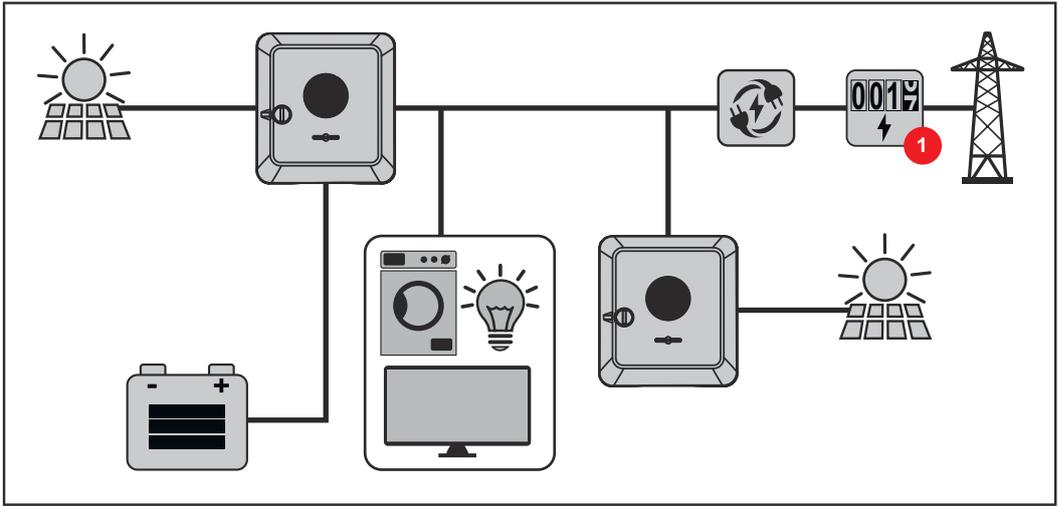
**Energiefluss-Richtung des Wechselrichters**
