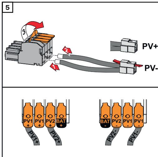
Die mitgelieferten PV+/PV- Kabel an den jeweiligen Anschlüssen anschließen.
