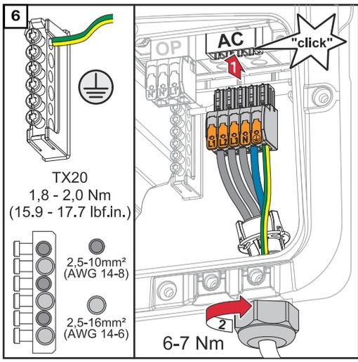
Die AC-Anschlussklemme in den AC-Steckplatz stecken, bis diese einrastet. Die Überwurfmutter der Zugentlastung mit einem Drehmoment von 6-7 Nm befestigen.
