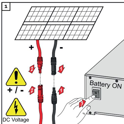
Solar modul-Stränge (+/-) verbinden. Die am Wechselrichter angeschlossene Batterie einschalten.
