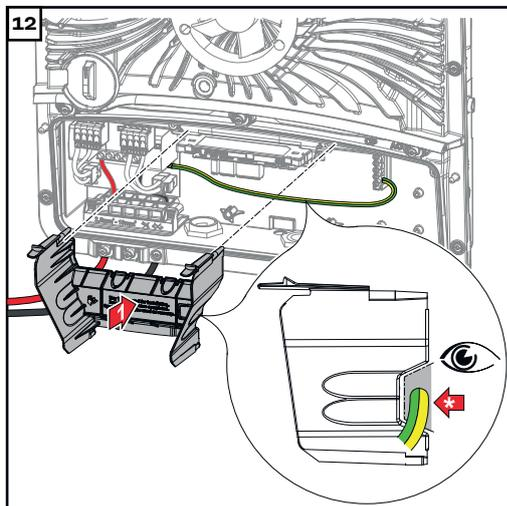
Abtrennung des Anschlussbereichs wieder einsetzen.
