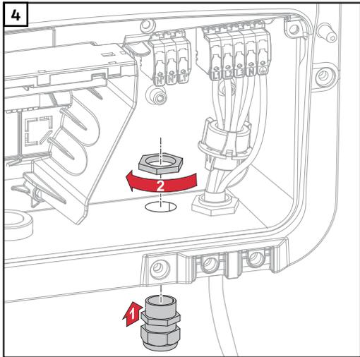
Zugentlastung in die Bohrung einsetzen und mit dem vom Hersteller angegebenen Drehmoment befestigen.
