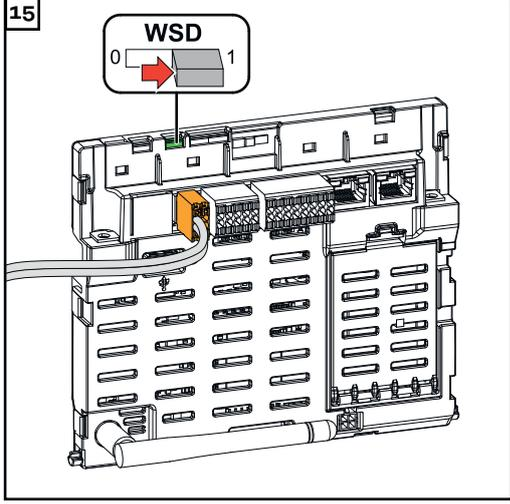
Kontrollieren ob sich der WSD-Switch auf Position 1 befindet, gegebenfalls einstellen (Werkseinstellung: Position 1).
