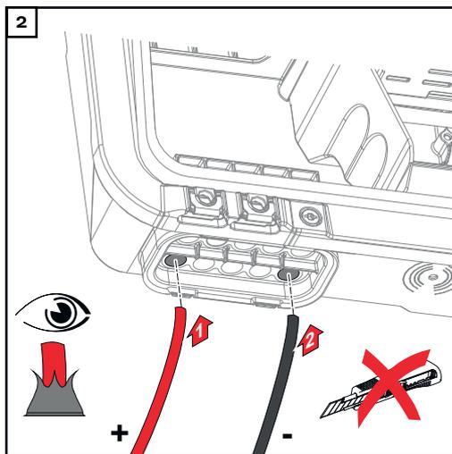
Die DC-Kabel mit der Hand durch die DC-Durchführungen stoßen.
