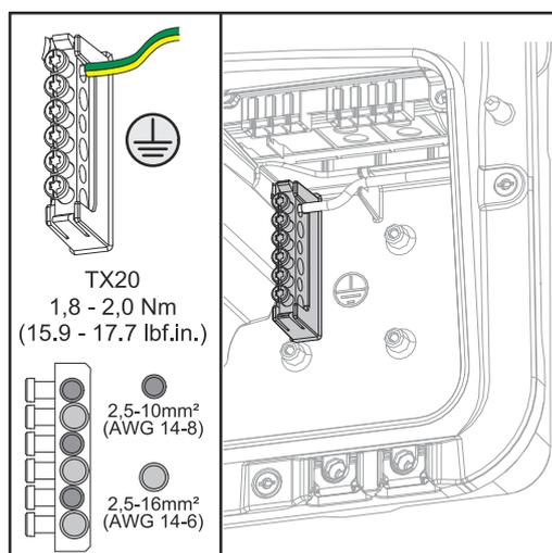
Die Erdungselektroden-Klemme  $\oplus$  bietet die Möglichkeit weitere Komponenten zu erden, wie z. B.:
