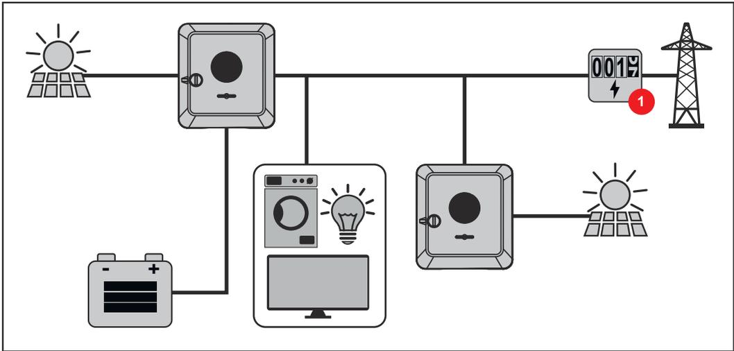
**Betriebsmodus - Wechselrichter mit Batterie, weiterem Wechselrichter und Notstrom-Funktion**
