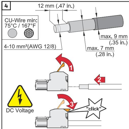
Kabel-Querschnitt gemäß der Angaben in **Zulässige Kabel** ab Seite **63** wählen. Von den Einzelleitern 12 mm abisolieren. Den Betätigungshebel der Anschlussklemme durch Anheben öffnen und den abisolierten Einzelleiter in den jeweils vorgesehenen Steckplatz bis zum Anschlag in die Anschlussklemme stecken. Danach den Betätigungshebel bis zum Einrasten schließen.
