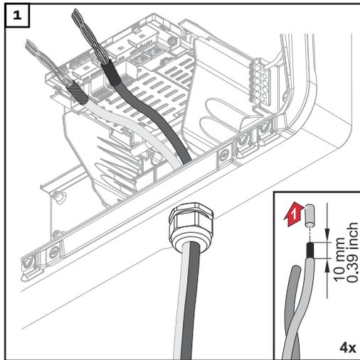
Von den Einzelleitern 10 mm abisolieren und gegebenenfalls Aderendhülsen montieren.
