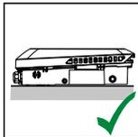
Der Wechselrichter ist für eine horizontale Montagelage geeignet.
