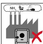
Den Wechselrichter nicht montieren:
