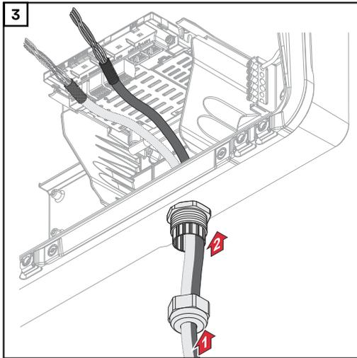
Datenkabel zuerst durch die Überwurfmutter der Zugentlastung und danach durch die Gehäuseöffnung führen.
