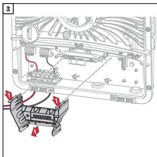
Abtrennung des Anschlussbereichs durch Betätigen der Snap-Haken entfernen.
