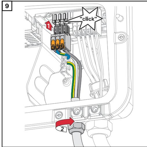
Die OP-Anschlussklemme in den OP-Steckplatz stecken, bis diese einrastet. Die Überwurfmutter der Zugentlastung mit dem vom Hersteller angegebenen Drehmoment befestigen.
