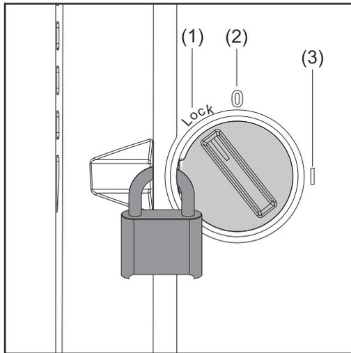
Der DC-Trennschalter verfügt über 3 Schalterstellungen:
