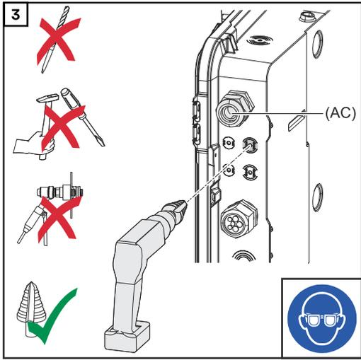
Die optionale Kabelführung mit einem Stufenbohrer aufbohren.
