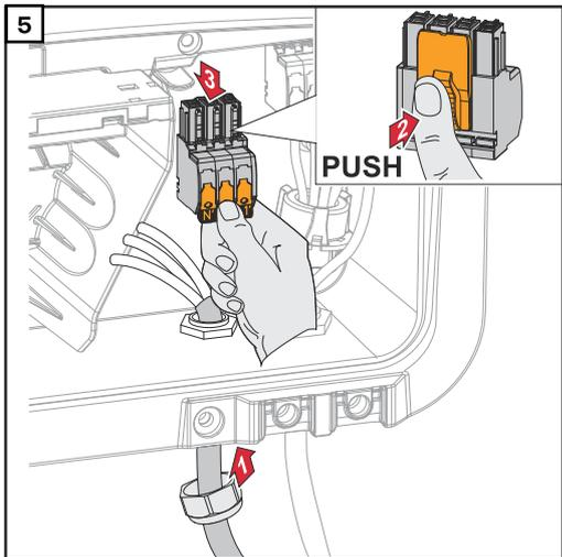
Das Netzkabel von unten durch die Zugentlastung durchführen.
