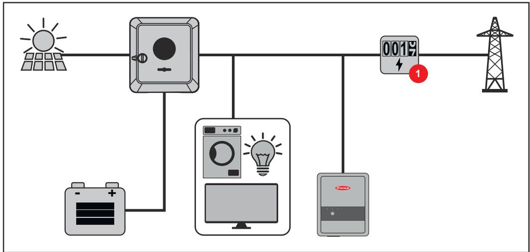
**Betriebsmodus - Wechselrichter mit Batterie, Ohmpilot und Notstrom-Funktion**
