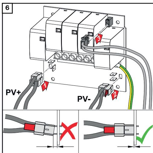
Die mitgelieferten Kabel an den jeweiligen Anschlüssen am Print anschließen.
