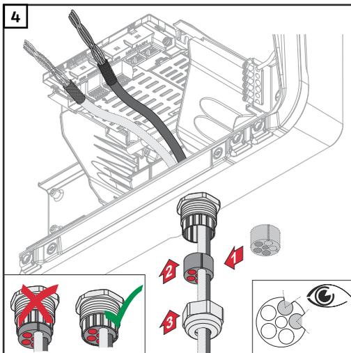
Dichtungsring zwischen der Überwurfmutter und der Gehäuseöffnung einsetzen. Die Datenkabel in die Kabelführung der Dichtung eindrücken. Danach die Dichtung bis zur Unterkante der Zugentlastung hineindrücken.
