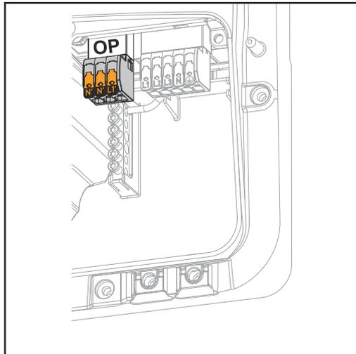
Mit dem PV Point können an der Opportunity Power (OP) Anschlussklemme bei Ausfall des öffentlichen Netzes einphasig elektrische Geräte bis zu einer maximalen Leistung von 3 kW versorgt werden, wenn dazu genügend Leistung von den Solarmodulen oder einer optionalen Batterie zur Verfügung steht. An der OP-Anschlussklemme liegt im netzgekoppelten Betrieb keine Spannung an, daher werden in diesem Betrieb die angeschlossenen Lasten nicht versorgt.
