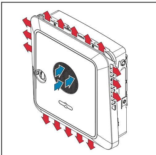
Umgebungsluft wird vom Lüfter an der Vorderseite angesaugt und an den Geräteseiten ausgeblasen. Die gleichmäßige Abfuhr der Wärme ermöglicht die Installation von mehreren Wechselrichtern nebeneinander.
