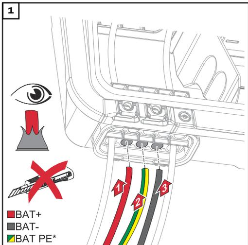
Die Batteriekabel mit der Hand durch die DC-Durchführungen stoßen.
