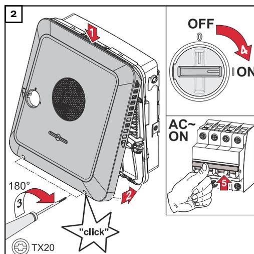
Den Gehäusedeckel von oben am Wechselrichter einhängen. Den unteren Teil des Gehäusedeckels andrücken und die 2 Schrauben mit einem Schraubendreher (TX20) und einer 180°-Drehung nach rechts befestigen.
