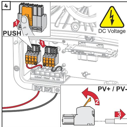
Die DC Push-in Anschlussklemmen aus den Steckplätzen entfernen und von den Kabel abschließen (nur bei bereits existierender Installation notwendig).
