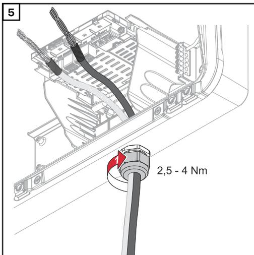
Die Überwurfmutter der Zugentlastung mit einem Drehmoment von min. 2,5 - max. 4 Nm befestigen.
