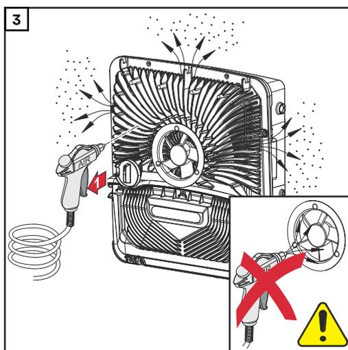
Die Schmutzablagerungen am Kühlkörper und Lüfter mit Druckluft, Tuch oder einem Pinsel entfernen.
