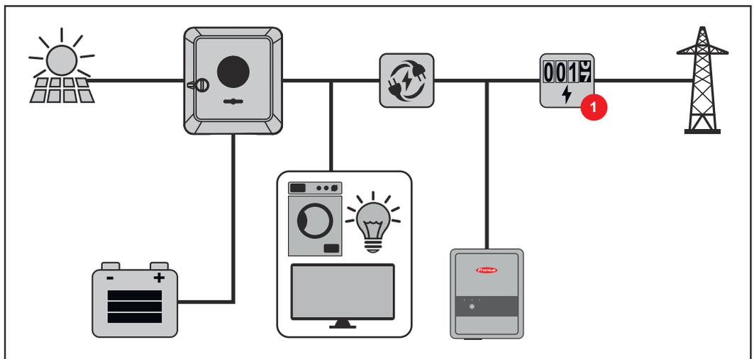
**Betriebsmodus - Wechselrichter mit Batterie und weiterem Wechselrichter**
