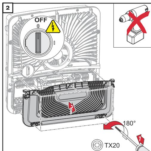
Die 5 Schrauben der Abdeckung des Anschlussbereiches mit einem Schraubendreher (TX20) und einer 180°-Drehung nach links lösen. Die Abdeckung des Anschlussbereiches vom Gerät nehmen.
