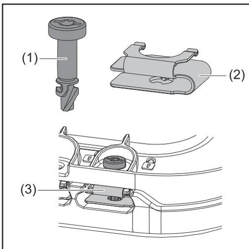
Zur Montage des Anschlussbereichs-Deckels sowie des Frontdeckels wird ein Schnellverschluss-System (3) eingesetzt. Das Öffnen und Schließen des Systems wird mit einer halben Umdrehung (180°) der Schraube mit Verliersicherung (1) in die Schnellverschlussfeder (2) realisiert.
