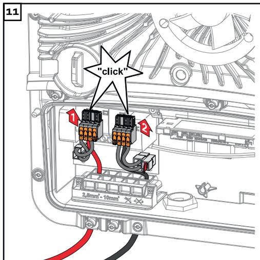
Die DC Push-in Anschlussklemmen mit einem hörbaren Klick in den jeweiligen Steckplatz anschließen.
