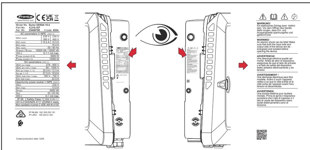
Am Leistungsschild ganz unten wird eine 4-stellige Ziffer (coded production date) angedruckt, aus der das Produktionsdatum berechnet werden kann. Zieht man von den ersten beiden Ziffern den Wert 11 ab, erhält man das Produktionsjahr. Die letzten beiden Ziffern stehen für die Kalenderwoche in der das Gerät produziert wurde.
