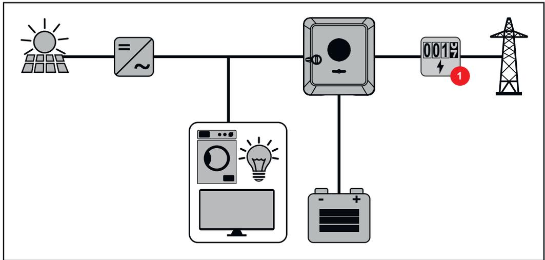
**Betriebsmodus - Wechselrichter mit Batterie und Notstrom-Funktion**
