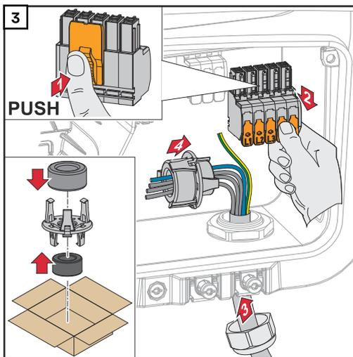
Die Verriegelung an der Rückseite der Anschlussklemme drücken und die AC-Anschlussklemme abziehen.
