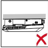
Den Wechselrichter nicht an der Decke montieren.
