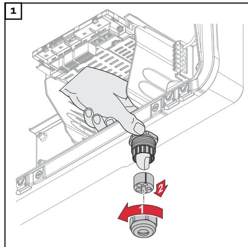
Überwurfmutter der Zugentlastung lösen und den Dichtungsring mit den Blindstopfen von der Innenseite des Gerätes herausdrücken.
