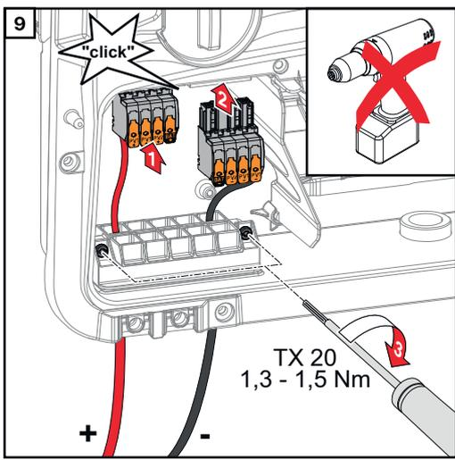
Die DC-Anschlussklemmen in den jeweiligen Steckplatz stecken, bis diese einrasten. Die Schrauben der Kabelführung mit einem Schraubendreher (TX20) und einem Drehmoment von 1,3 - 1,5 Nm am Gehäuse befestigen.
