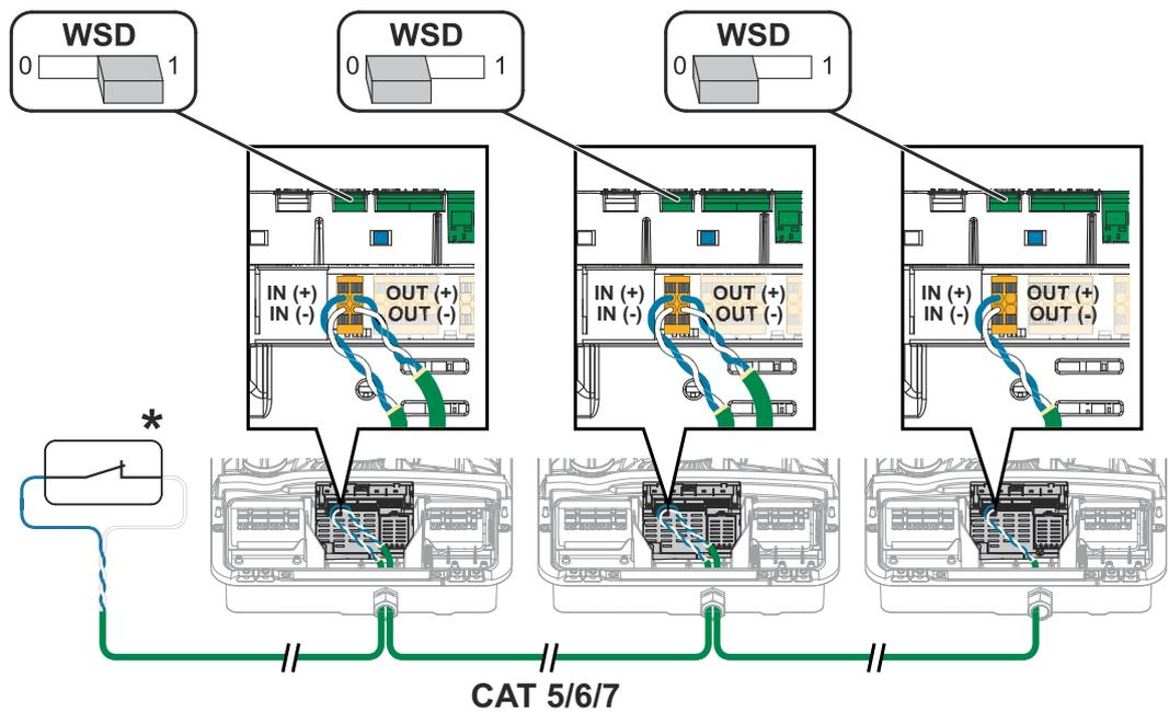
\* Potentialfreier Kontakt der Auslöseeinrichtung (z. B. zentraler NA-Schutz). Werden mehrere potentialfreie Kontakte in einer WSD-Kette verwendet sind diese in Serie zu verschalten.
