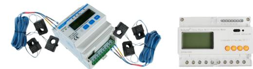
Ab 30,5kVA/44A muss statt des mitgelieferten DTSU666 der DTSU666-2CT oder der DTSD1352-C1(6)A mit bauseitigen CTs zugekauft werden. (Sekundärseitig 5A)
