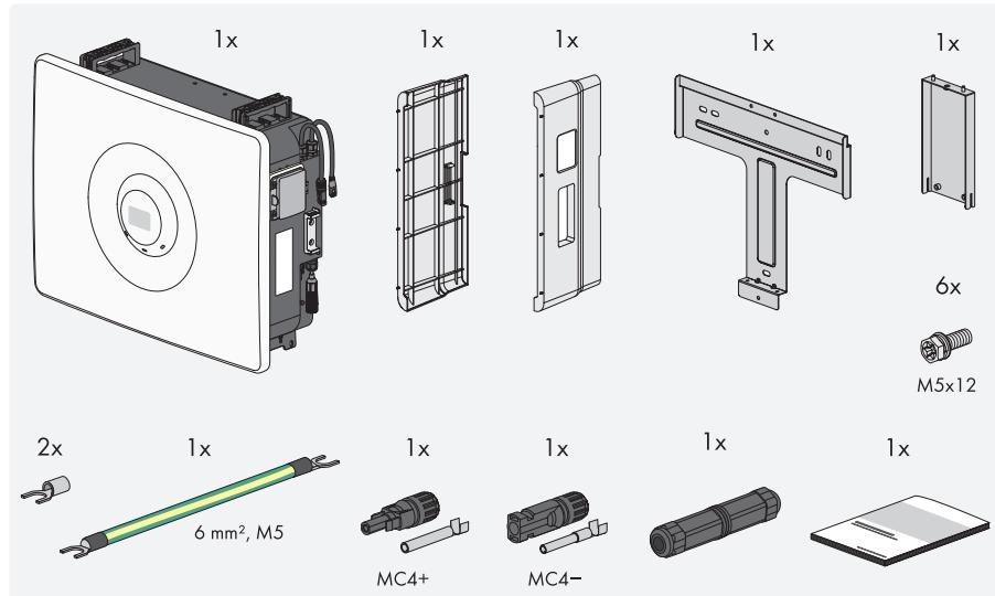
**[en]** Scope of delivery of base **[de]** Lieferumfang Sockel **[es]** Contenido de la entrega con pedestal **[fr]** Contenu de la livraison socle **[it]** Contenuto della fornitura zoccolo **[nl]** Leveringsomvang sokkel **[pt]** Volume de fornecimento da base
