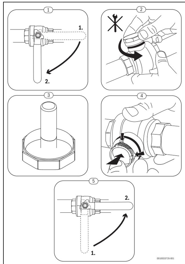
Bild 14 Siebreinigung
