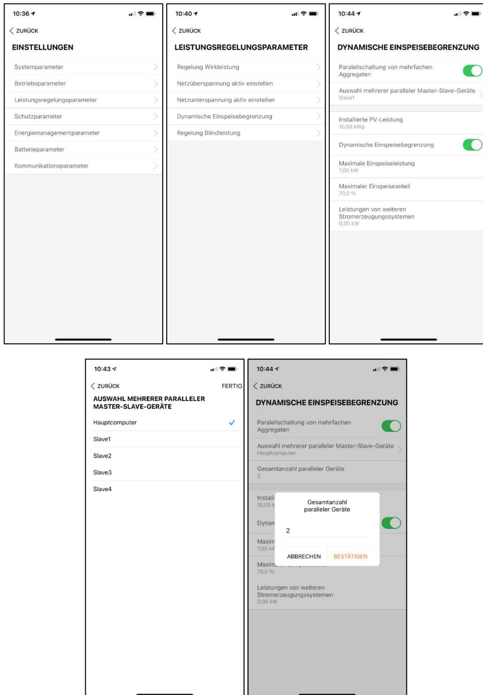
Für die Slave-Wechselrichter wählen Sie einfach jeden Wechselrichter als entsprechende Slave-Nummer in der RS485-Daisy-Chain.
