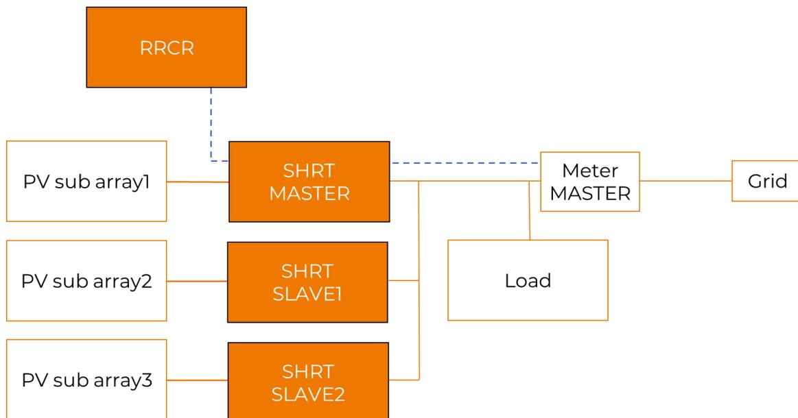
Mit einem Funkrundsteuerempfänger kann darüber hinaus eine parallele Ansteuerung eines 3-phasigen Hybrids und eines weiteren PV-Wechselrichters ermöglicht werden. Für diese Zwecke wird das Datenkabel abgehend vom Rundsteuerempfänger mittels Koppelrelais aufgetrennt und separat an beide Wechselrichter angebunden (siehe blau gestrichelte Linie in nachfolgendem Schaubild).
