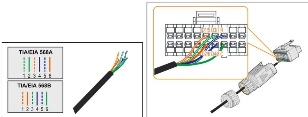
Die Verbindung von Wechselrichter und Rundsteuerempfänger wird nach nachfolgendem Anschlussschema ausgeführt:
