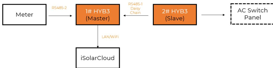
Beachten Sie, dass bei Verwendung des Parallelmodus der Nachrüstungsmodus nicht verwendet werden sollte. Wenn also 2 Hybride parallel installiert sind, sollte das System keinen weiteren PV-Wechselrichter (von Sungrow oder einer anderen Marke) enthalten.
