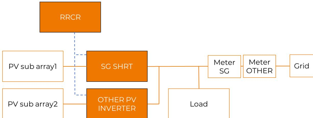
Im Falle einer Leistungsreduzierung durch den Rundsteuerempfänger werden sowohl der 3-phasige Hybrid als auch der PV-Wechselrichter gleichermaßen in ihrer Leistung reduziert. Gibt zum Beispiel der Netzbetreiber eine Reduzierung auf 60% der Nominalleistung vor, so werden beide Wechselrichter, unabhängig von der Versorgungssituation oder dergleichen, auf 60% ihrer Leistung beschränkt.
