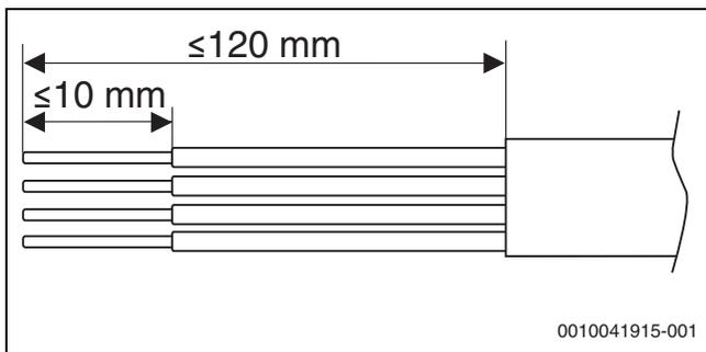
Bild 38 Abisolierung CAN-BUS
