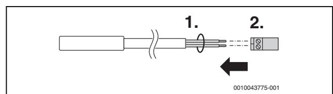
Bild 42 Kabelbinder und Stecker am Kabel anbringen
