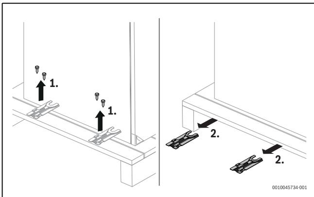
Bild 8 Transportsicherungen entfernen
