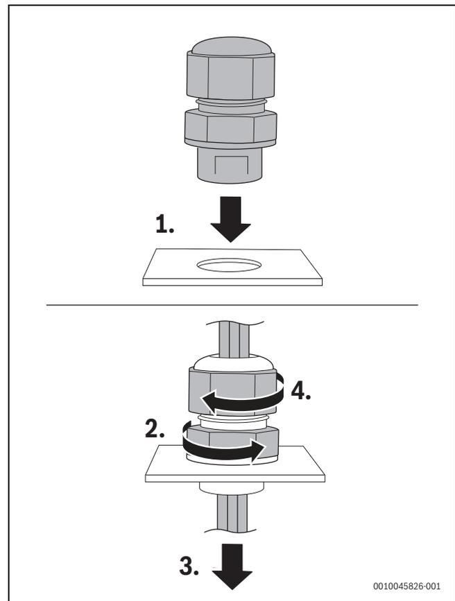
Bild 29 Kabelverschraubungen einsetzen
