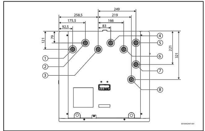
**Bild 4** Ansicht von oben: Positionen der Anschlüsse
