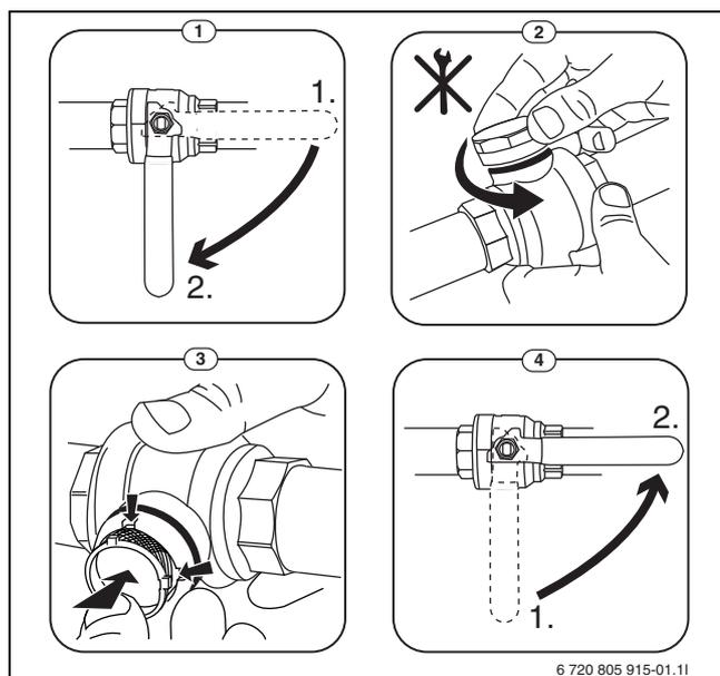
Bild 50 Filterventil reinigen
