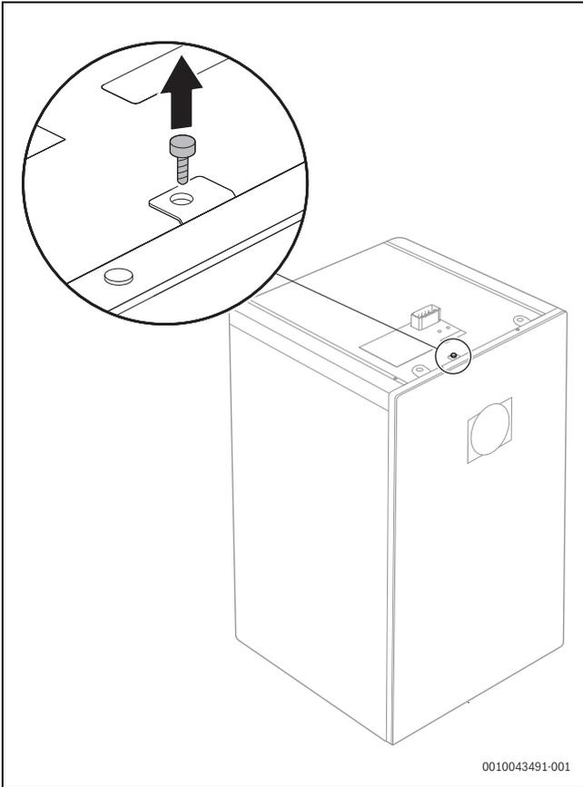
Bild 11 Sicherungsschraube lösen
