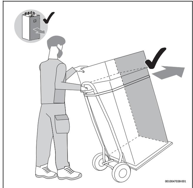
Bild 9 Inneneinheit mit einer Sackkarre transportieren
