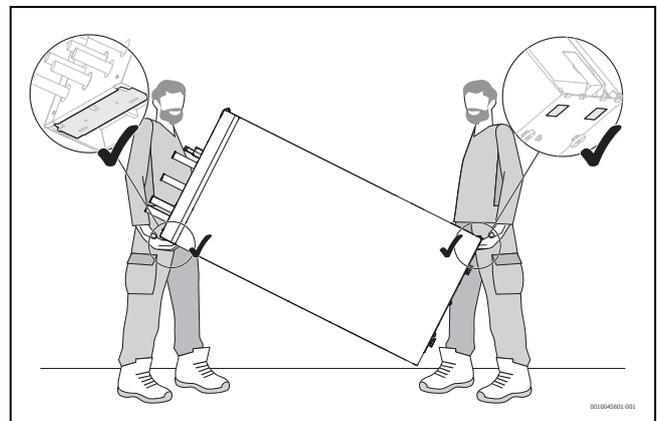
Bild 10 Inneneinheit anheben
