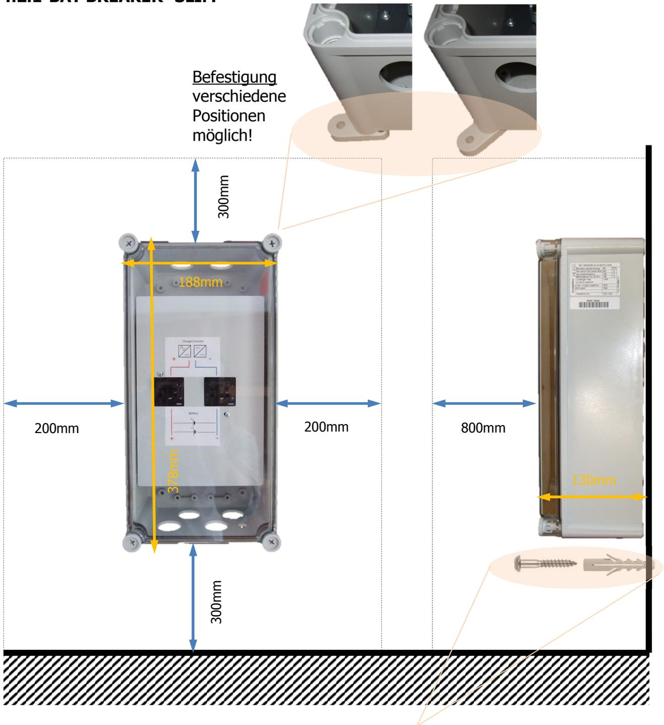
Wählen Sie **je nach Untergrund** eine passende Befestigungsart, **z.B.** mittels 4 x Spreizdübel S8 und 4 x Spanplatten/Holzschraube Ø5.5
