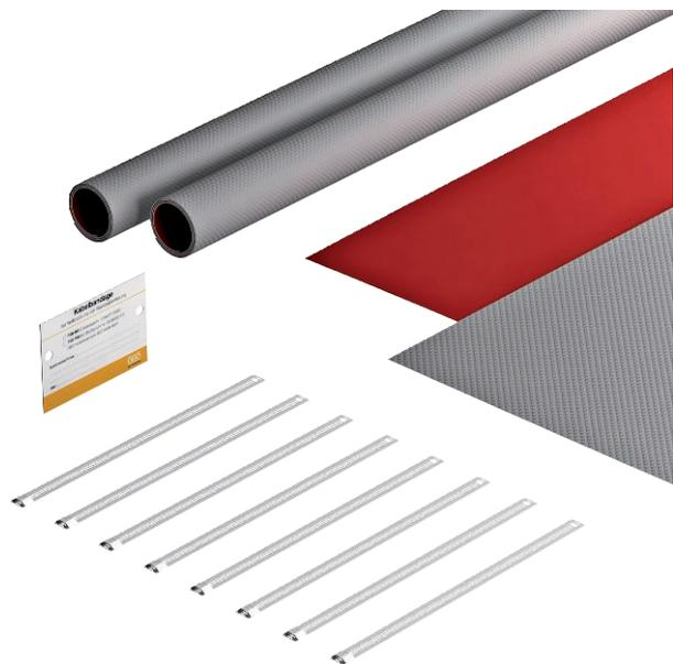
Komplettsset zur Umhüllung von Kabelbündeln oder Kabeltrag-Systemen ohne Deckel zur Verhinderung der Brandweiterleitung. Anwendung im Außenbereich. Die Sets enthalten jeweils 4 Abschnitte der witterungsbeständigen Kabelbandage FSB-WB, 8 Metallbandschellen und ein Kennzeichnungsschild. Ausreichend für ca. 2 m Länge.
