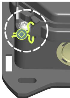
Mit der Plombierung der Schutzabdeckung kann ein unbefugter Zugriff auf das Innere des Gerätes sichtbar gemacht werden. Damit sind unter anderem der Zugriff auf den Anschluss der Spannungsversorgung, elektrische Grundeinstellungen und Veränderungen an den Komponenten gesichert.
