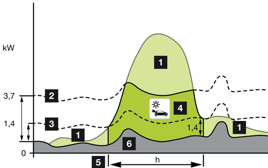
Bei Elektrofahrzeugen, die 3-phasig geladen werden, liegt die Ladeleistung zwischen 4,1 und 11 kW. Dies bedeutet, dass die Ladung erst gestartet wird, wenn mind. 4,1 kW Überschuss an PV-Energie zur Verfügung steht, und unterbrochen oder beendet wird, wenn diese unter 4,1 kW fällt.
