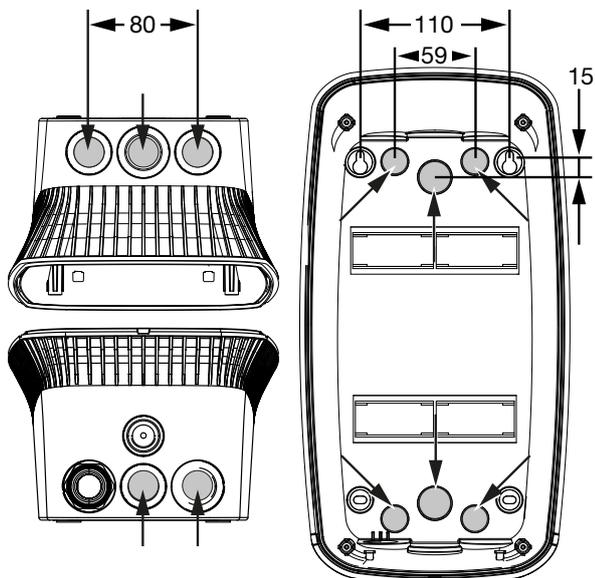
1. Benötigte Kabeleinführung aus der Wallbox mit geeignetem Werkzeug herausschneiden. Kabeleinführungen sind an der Rückseite, Unterseite und Oberseite angebracht.
