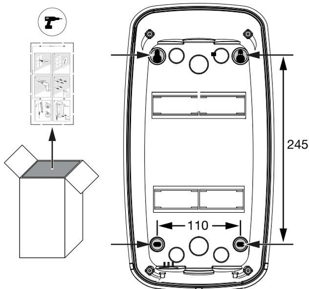
1. Bohrlöcher anhand der mitgelieferten Bohrschablone oder der Abbildung anzeichnen. Dabei auf eine waagerechte Ausrichtung achten.
