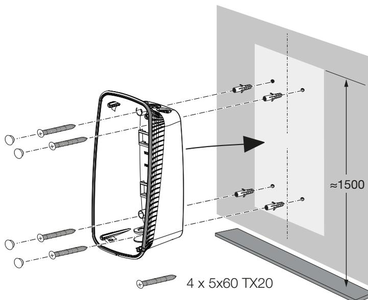
1. Wallbox unter Verwendung von Dübeln und Schrauben an der Wand festschrauben, dabei die Montagehinweise auf der Bohrschablone der Wallbox beachten.
