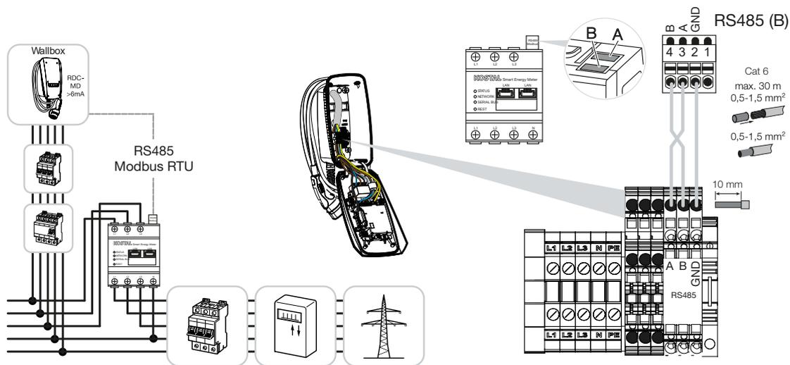
8. Kommunikationsleitung am Energiezähler anschließen.
