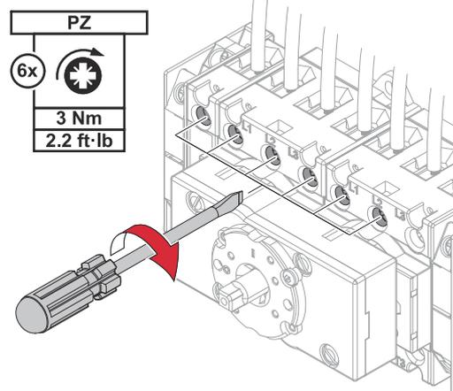
Die Einzelleiter (L1, L2, L3) und den Neutralleiter (N) in den Anschlussklemmen festschrauben. Die beiden Neutralleiter (N') in den Anschlussklemmen festschrauben. Zulässige Anschluss-Schrauben und Drehmomente siehe **Zulässige Anschluss-Schrauben** auf Seite **19**.
