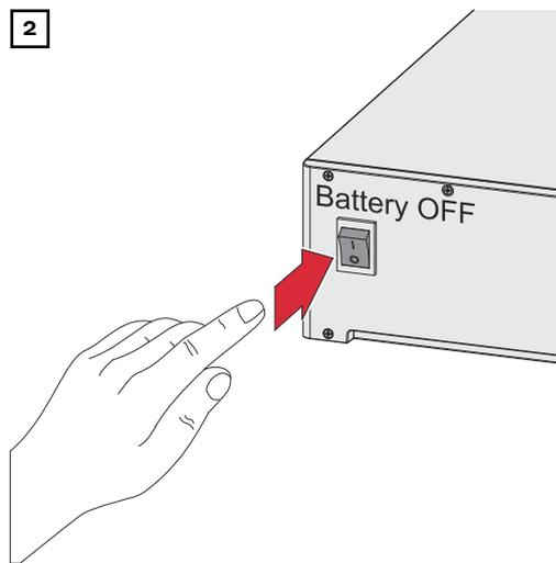
Die am Wechselrichter angeschlossene Batterie ausschalten.
