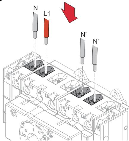
Den vom Netz kommenden Einzelleiter (L1) und den vom Netz kommenden Neutralleiter (N) in die Anschlussklemmen stecken. Die beiden Neutralleiter (N') vom Notstrom-Kreis in die Anschlussklemmen stecken.
