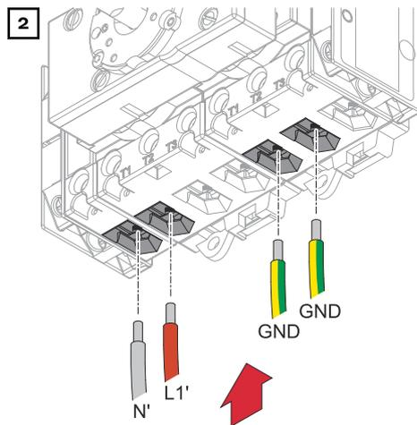
Den vom Notstrom-Kreis kommenden Einzelleiter (L1') und den vom Notstrom-Kreis kommenden Neutralleiter (N') in die Anschlussklemmen stecken. Die Erdungskabel (GND) der Hausverkabelung in die Anschlussklemmen stecken.
