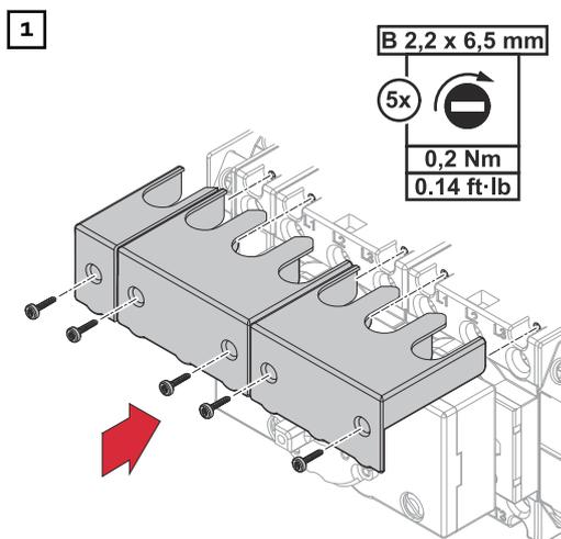
An allen Last-Trennschaltern 63 A je eine Schutzabdeckung oben montieren. Für die Montage die Schrauben aus dem Lieferumfang verwenden.
