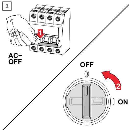
Den Leitungs-Schutzschalter ausschalten. DC-Trenner in die Schalterstellung „Aus“ (OFF) stellen.
