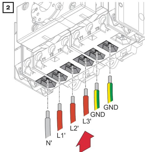
Die vom Notstrom-Kreis kommenden Einzelleiter (L1', L2', L3') und den vom Notstrom-Kreis kommenden Neutralleiter (N') in die Anschlussklemmen stecken. Die Erdungskabel (GND) der Hausverkabelung in die vorgesehenen Anschlussklemmen stecken.
