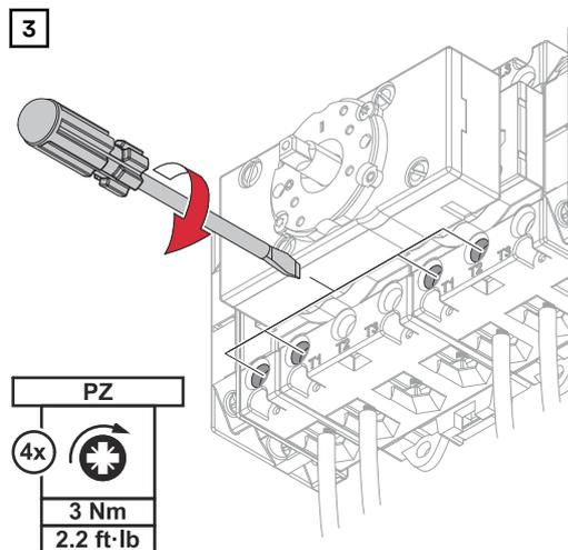
Den Einzelleiter (L1') und den Neutralleiter (N') in den Anschlussklemmen festschrauben. Die Erdungskabel (GND) der Hausverkabelung in den Anschlussklemmen festschrauben.
