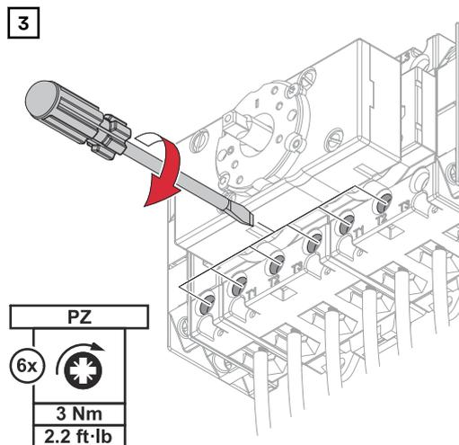
Die Einzelleiter (L1', L2', L3') und den Neutralleiter (N') in den Anschlussklemmen festschrauben. Die Erdungskabel (GND) der Hausverkabelung in den Anschlussklemmen festschrauben.
