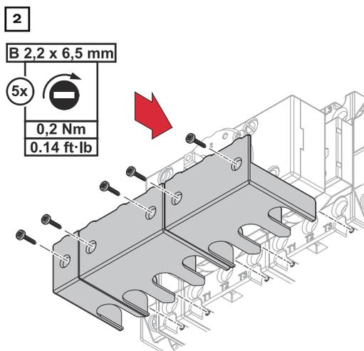
An allen Last-Trennschaltern 63 A je eine Schutzabdeckung unten montieren. Für die Montage die Schrauben aus dem Lieferumfang verwenden.
