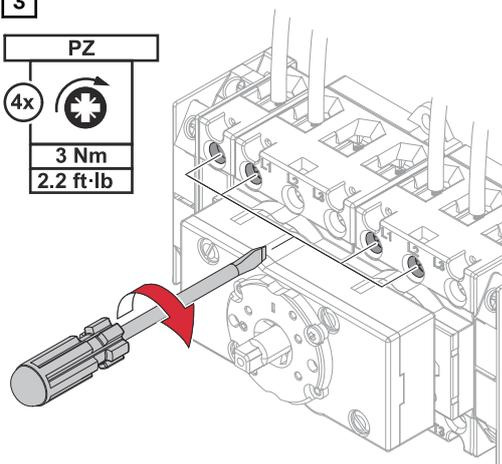
Den Einzelleiter (L1) und den Neutralleiter (N) in den Anschlussklemmen festschrauben. Die beiden Neutralleiter (N') in den Anschlussklemmen festschrauben. Zulässige Anschlussschrauben und Drehmomente siehe [Zulässige Anschluss-Schrauben](#) auf Seite [19](#).
