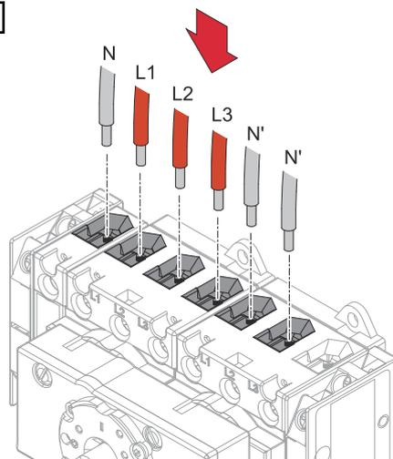
Die vom Netz kommenden Einzelleiter (L1, L2, L3) und den vom Netz kommenden Neutralleiter (N) in die Anschlussklemmen stecken. Die beiden Neutralleiter (N') vom Notstrom-Kreis in die Anschlussklemmen stecken.
