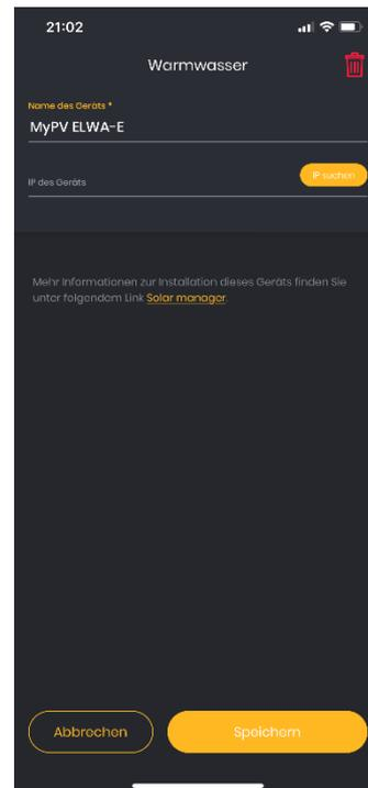
Sie können anschliessend die IP manuell eingeben oder mittels «IP suchen» eine Liste von möglichen IP-Adressen anzeigen und die korrekte IP auswählen. Klicken Sie auf «Speichern».
