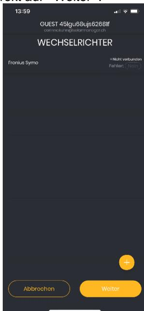
7. Der soeben erfasste Wechselrichter wird in der Liste angezeigt. Wenn Sie die Installation vorbereiten, bleibt der Status des Geräts auf «nicht verbunden». Erledigen Sie die Installation erst vor Ort beim Kunden, wechselt der Status nach kurzer Zeit (nach einem Reload) zu «verbunden». Erfassen Sie mittels «+» einen zweiten Wechselrichter oder klicken Sie auf «Weiter».
