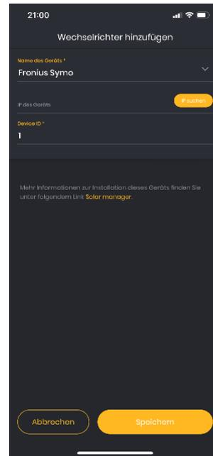
6. Wählen Sie den bei Ihrem Kunden installierten Wechselrichter aus der Liste aus (unter «Name des Geräts»). Wenn Sie die Installation vorbereiten, lassen Sie die IP leer. Angaben zu den weiteren Einstellungen wie «Device ID» erhalten Sie unter dem gelb markierten Link «Solar Manager» direkt unterhalb der Einstellungen. Klicken Sie auf «Speichern».
