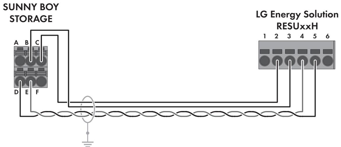
Abbildung 10: Verkabelungsprinzip SBS3.8-US-10 / SBS5.0-US-10 / SBS6.0-US-10 mit RESU7H / RESU10H
