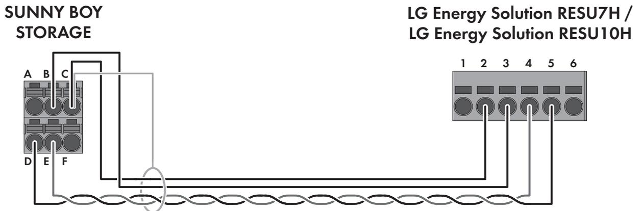
Abbildung 1: Verkabelungsprinzip SBS2.5-1VL-10 mit RESU7H / RESU10H
