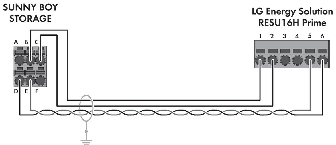
Abbildung 12: Verkabelungsprinzip SBS3.8-US-10 / SBS5.0-US-10 / SBS6.0-US-10 mit RESU 16H Prime
