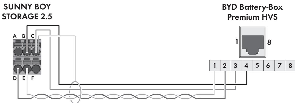
Abbildung 3: Verkabelungsprinzip SBS2.5-1VL-10 mit Battery-Box Premium HVS
