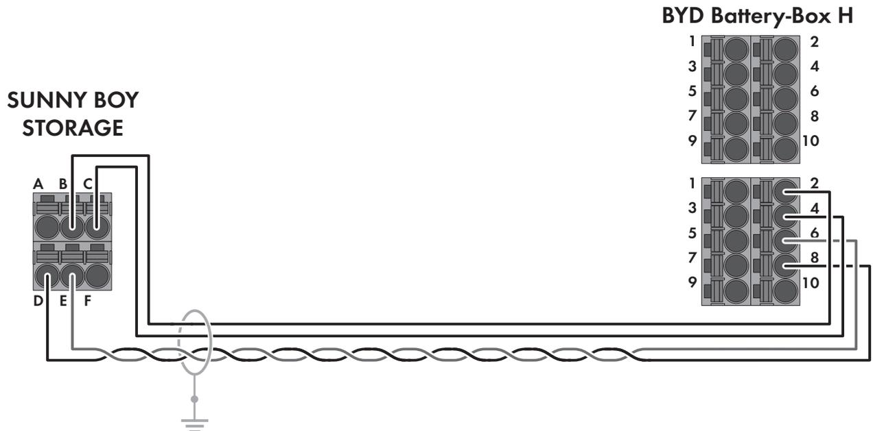
Abbildung 7: Verkabelungsprinzip SBS3.7-10 / SBS5.0-10 / SBS6.0-10 mit Battery-Box H
