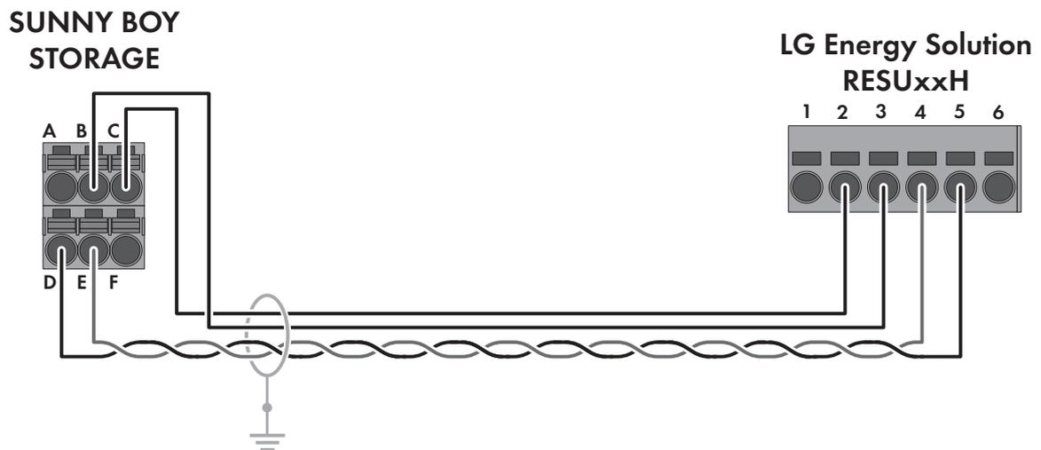
Abbildung 4: Verkabelungsprinzip SBS3.7-10 / SBS5.0-10 / SBS6.0-10 mit RESU7H / RESU10H
