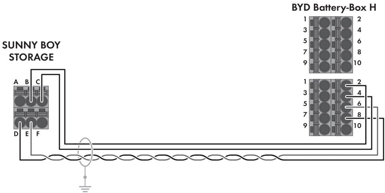
Abbildung 11: Verkabelungsprinzip SBS3.8-US-10 / SBS5.0-US-10 / SBS6.0-US-10 mit Battery-Box H
