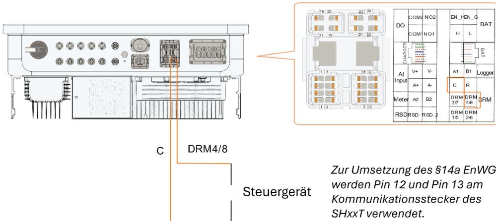
Die Logik für den Anschluss eines Rundsteuerempfängers bei gleichzeitiger Umsetzung der Steuerbarkeit nach §14a EnWG definiert sich wie folgend.
