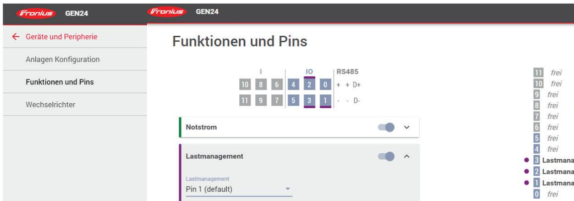
Abbildung 4b: Funktionen und Pin Aktivierung am GEN24 Plus
