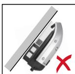
Den Wechselrichter nicht an der Decke montieren.
