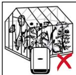
Den Wechselrichter nicht montieren in:
