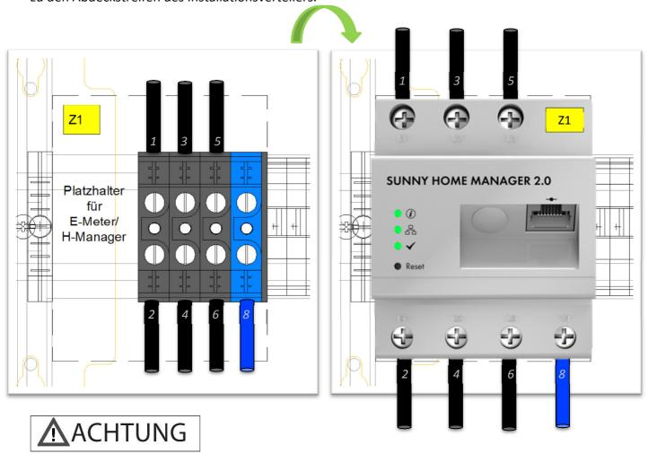
Beachten Sie beim Einbau des Energy Meters / des Home Managers das **maximal zulässige Drehmoment** von **2,0 Nm**!
