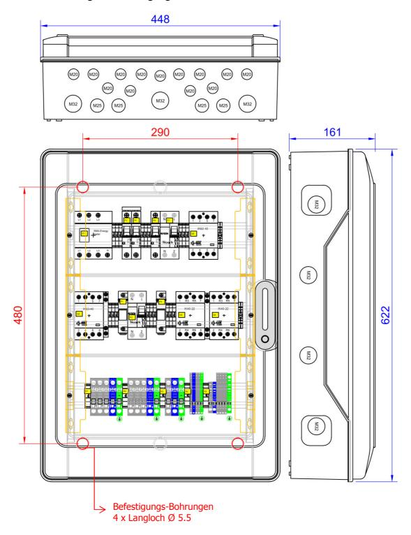
Wählen Sie <u>je nach Untergrund</u> eine passende Befestigungsart, <u>z.B.</u> mittels 4 x Spreizdübel S8 und 4 x Spanplatten/Holzschraube Ø5.5
