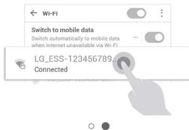
Drücken Sie die WLAN-Taste an der Unterseite des ESS und gehen Sie zum Menü Einstellungen> WLAN und wählen Sie ESS, um eine Verbindung herzustellen. Das ESS WLAN-Passwort finden Sie auf der rechten Seite des ESS-Geräts unter WLAN-Passwort.
