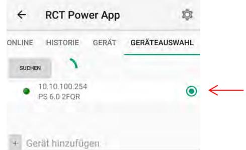
7 Wenn die Verbindung mit einem Wechselrichter hergestellt ist, wird der Name angezeigt und das Symbol umrandet.
