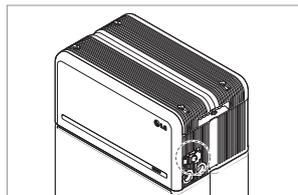
1. Wechselrichter auf AUS schalten, bevor Sie mit der Deinstallation des Akkus beginnen
