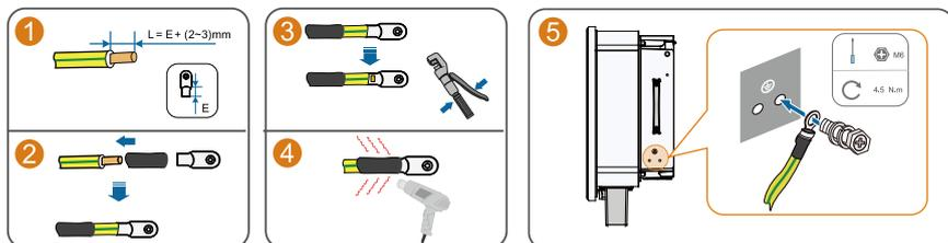
AC Connection (For a multi-core cable) / Conexão CA (para cabos multipolares) / Conexión de CA (para cables de varios núcleos) / توصيل التيار المتردد (الكابل متعدد الأقطاب)
