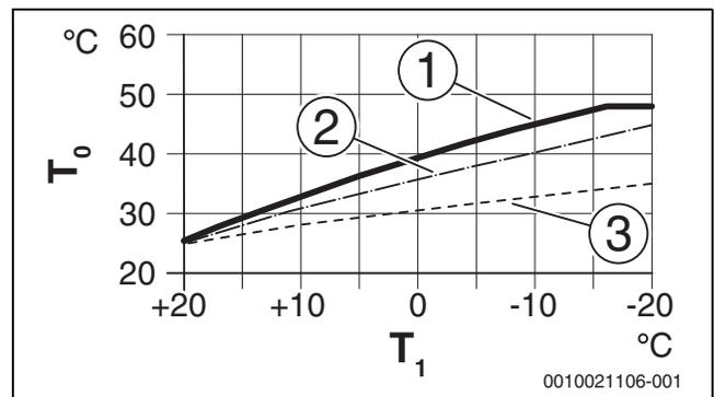
Bild 2 Einstellung der Heizkurve für Fußbodenheizung Steigung über Auslegungstemperatur T<sub>0</sub> und minimale Außentemperatur T<sub>1,min</sub>
