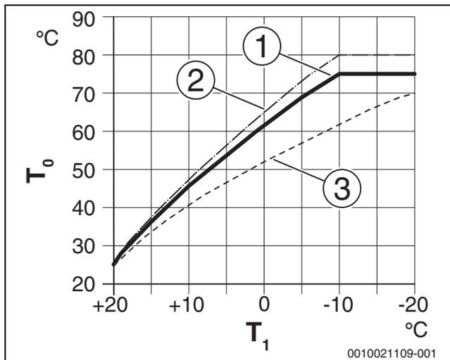
Bild 4 Einstellung der Heizkurve für Heizkörper
