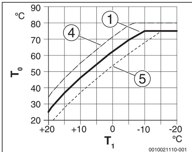
Bild 5 Einstellung der Heizkurve für Heizkörper
