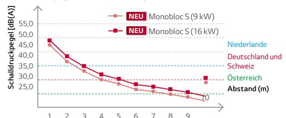
\* Der Schalldruckpegel wird vom Schalleistungspegel des geräuscharmen Modus auf der Grundlage eines Zuschlags für Tonhaltigkeit von 0 dB und der Installation im Freifeld umgerechnet.
