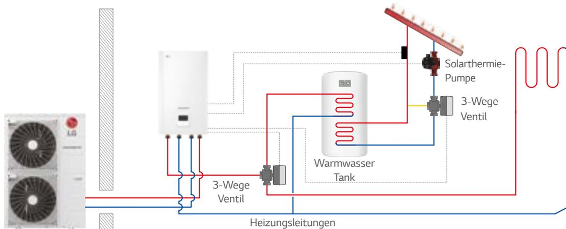
\* Modellhinweis: Monobloc Serie 1 benötigt Solarthermie-Kit (PHLLA). Monobloc S, Hydrosplit, Hydrobox erfordern bauseitigen Temperatursensor PT1000.
