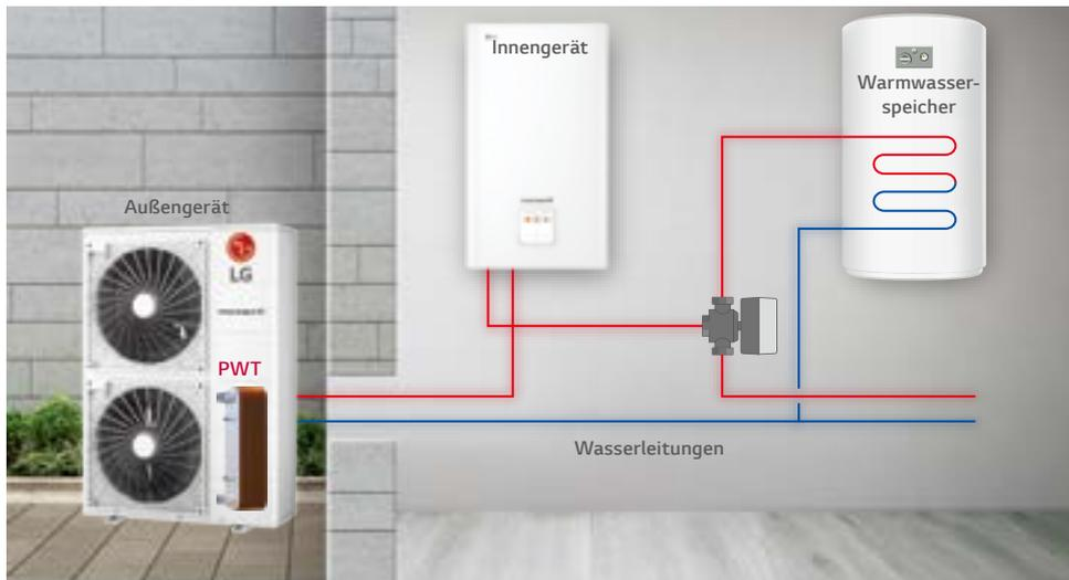
\* PWT: Plattenwärmetauscher
