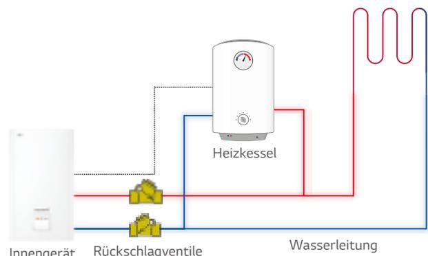
\* Heizkessel eines Fremdanbieters müssen mit einer integrierten Wasserpumpe ausgestattet sein.
