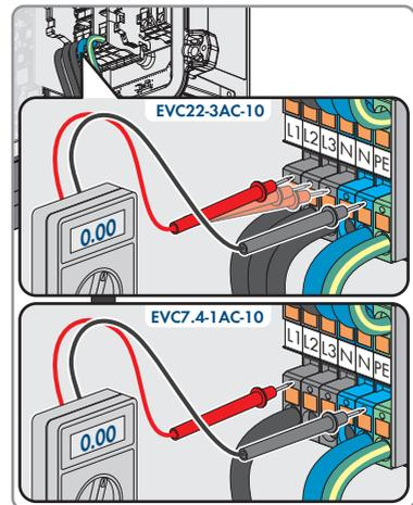
5. Bei Bei EVC22-3AC-10 Spannungsfreiheit an der Klemmleiste für den Anschluss des öffentlichen Stromnetzes nacheinander zwischen L1 und PE, L2 und PE und L3 und PE mit einem geeignetem Messgerät feststellen.
