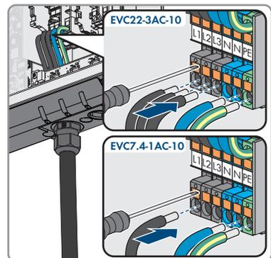
6. Sicherstellen, dass die Klemmstellen mit den richtigen Leitern belegt sind.
