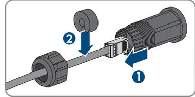
5. Kabeltülle in die Gewindehülse drücken.
