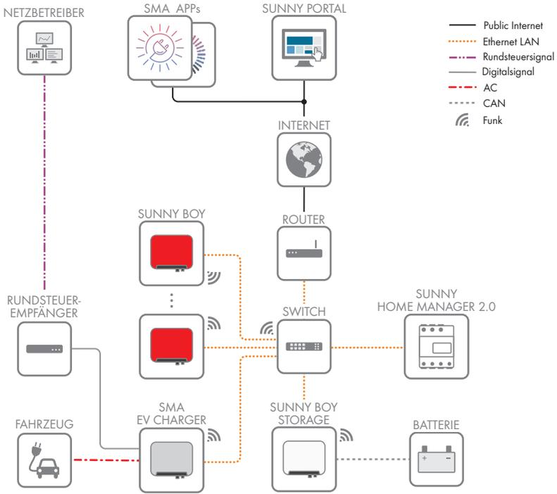
Abbildung 5: Aufbau Anlagenkommunikation
