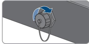
9. Die Klemmleisten für den Anschluss der Signalquelle an den digitalen Eingang aus der Buchse für den Anschluss einer digitalen Signalquelle entfernen.
