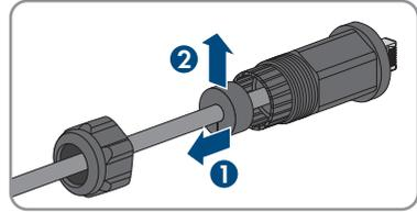
7. Das Netzwirkabel aus der Gewindehülse und der Überwurfmutter herausführen.
