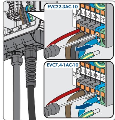
15. Das Ladekabel durch die Biegeschutzspirale und die Kabelverschraubung aus dem Produkt führen. Dazu wenn nötig, die Biegeschutzspirale lösen.
