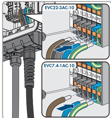
7. Sicherstellen, dass die Klemmstellen mit den richtigen Leitern belegt sind.
