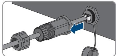
6. Kabeltülle aus Gewindehülse herausnehmen und Kabeltülle vom Netzwirkabel entfernen.
