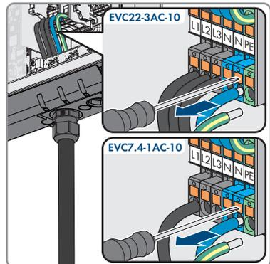
13. Das AC Kabel durch die Kabelverschraubung aus dem Produkt führen. Dazu wenn nötig die Überwurfmutter der Kabelverschraubung lösen.
