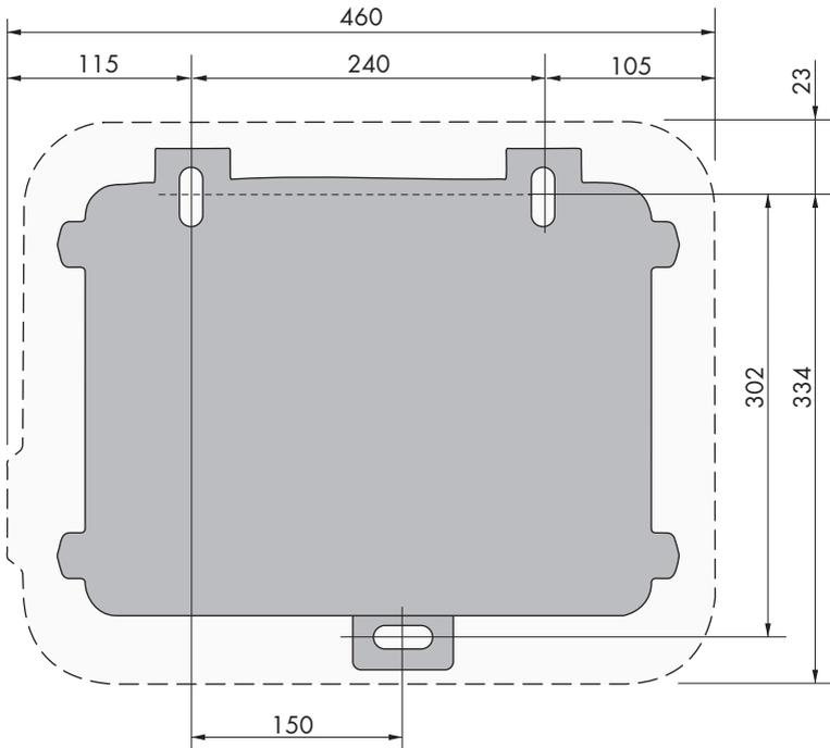
Abbildung 7: Position der Befestigungspunkte (Maßangaben in mm)
