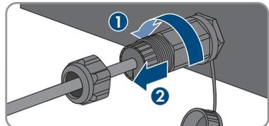
5. Den Stecker des Netzkabels entriegeln und aus der Buchse am Produkt abziehen.
