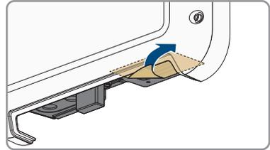
7. Den Montagewinkel mit Spanscheibe und Zylinderschraube am Produkt montieren (Drehmoment:  $6 \text{ Nm} \pm 0,3 \text{ Nm}$ ).
