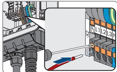
6. Bei EVC22-3AC-10 die Leiter L1, L2, L3, N und PE entsprechend der Beschriftung anschließen. Bei EVC7.4-1AC-10 die Leiter L1, N und PE entsprechend der Beschriftung anschließen. Dazu die Klemmstelle mit einem Schraubendreher öffnen und jeden Leiter bis zum Anschlag in die jeweilige Klemmstelle stecken.
