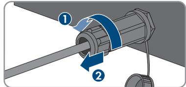
4. Gewindehülse vom Gewinde der Netzbuchse am Produkt abdrehen.
