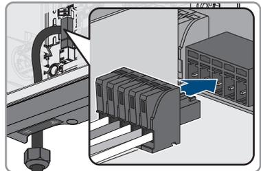
12. Durch leichtes Ziehen an den Leitern sicherstellen, dass die Leiter fest in den Klemmstellen stecken.
