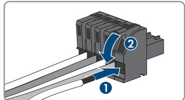
11. Die Klemmleiste in die Buchse für den Anschluss einer digitalen Signalquelle stecken.
