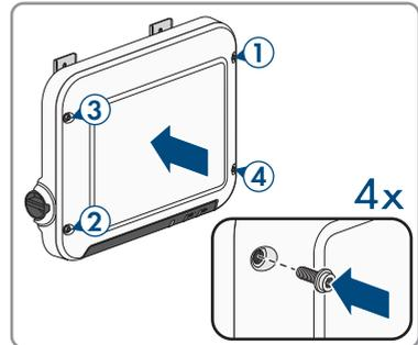
3. Die 3 Schrauben der Anschlusskappe in der vorgegebenen Reihenfolge fest anziehen (TX20, Drehmoment:  $3,5 \text{ Nm}$ ).
