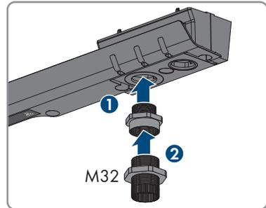
2. Die Kabelverschraubung für den Anschluss des Ladekabels an der Anschlusskappe montieren:
