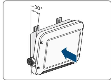
2. Die Schrauben in der abgebildeten Reihenfolge anziehen (TX25, Drehmoment:  $6 \text{ Nm} \pm 0,3 \text{ Nm}$ ). Die erste Schraube zum Schluss erneut anziehen.
