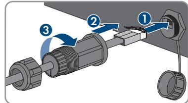
7. Die Überwurfmutter auf die Gewindehülse drehen.
