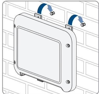
9. Sechskantschraube mit Unterlegscheibe durch den Montagewinkel stecken und mit einem geeigneten Werkzeug festziehen (Drehmoment:  $6 \text{ Nm} \pm 0,3 \text{ Nm}$ ).
