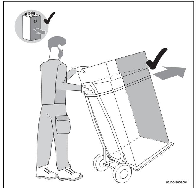
Bild 9 Inneneinheit mit einer Sackkarre transportieren
