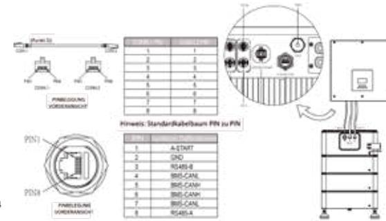
B: Schließen Sie das Erdungskabel an, um sicherzustellen, dass alle Batterien geerdet sind. Die Verdrahtung muss in der unten gezeigten Reihenfolge angeschlossen werden.
