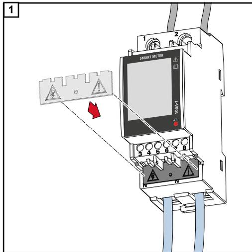
Die Schutzabdeckung in die Führung einsetzen und festdrücken.
