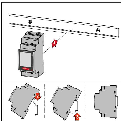
Der Fronius Smart Meter TS kann auf einer DIN-Hutschiene 35 mm montiert werden. Das Gehäuse hat eine Abmessung von 2 Teileinheiten (TE) gemäß DIN 43880.
