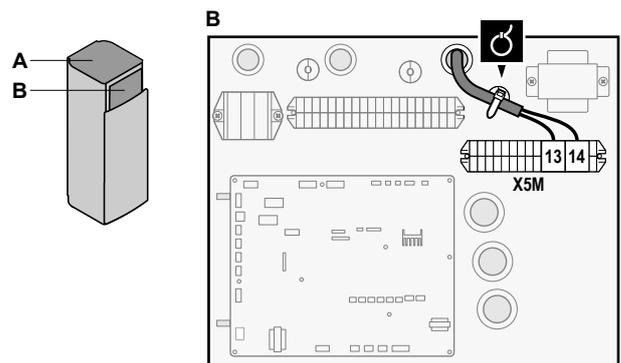
3 Befestigen Sie das Kabel mit Kabelbindern an den Kabelbinderhalterungen.
