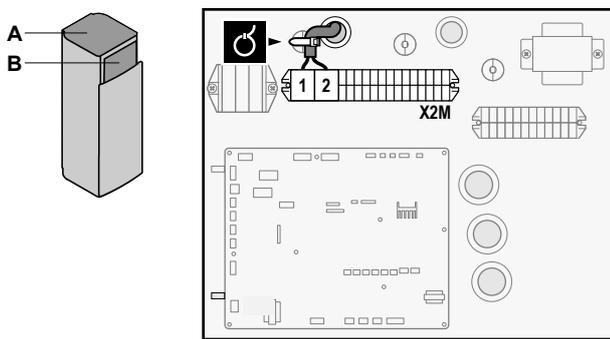
3 Befestigen Sie das Kabel mit Kabelbindern an den Kabelbinderhalterungen.
