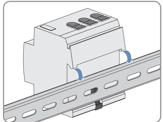
2. Die unteren Halterungen in die untere Kante der Hutschiene einrasten.
