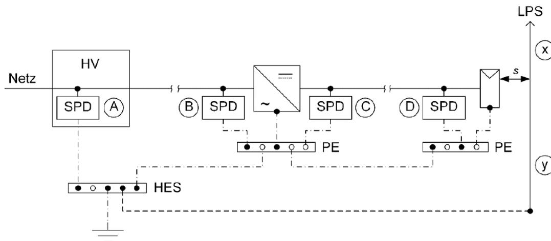
Abbildung 1: Beispiel einer Installationsanforderung für SPDs in einer PV-Anlage (Quelle: OVE-Richtlinie R 6-2-2)
