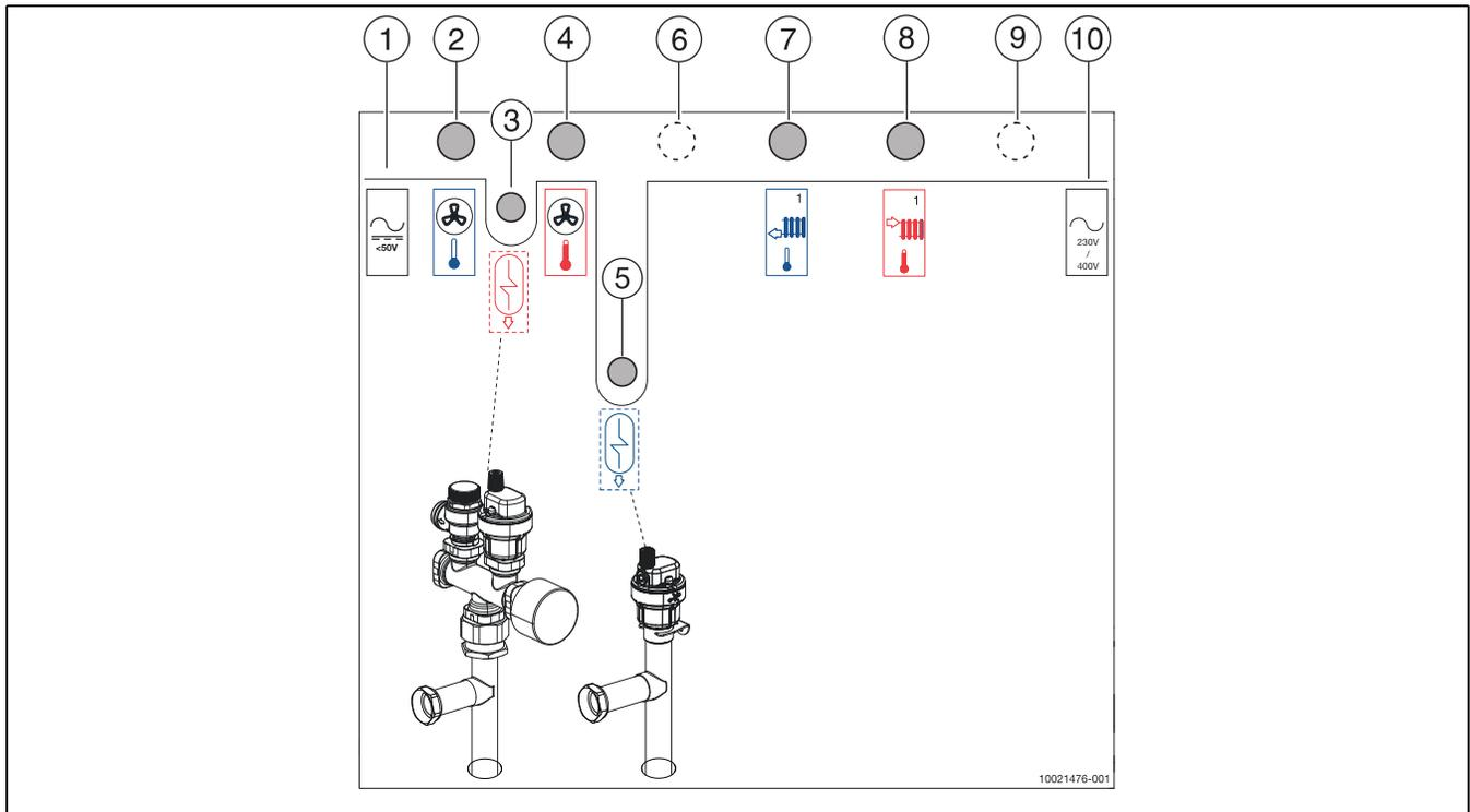
Bild 6 Anschlüsse der Inneneinheit mit ungemischtem Kreis
