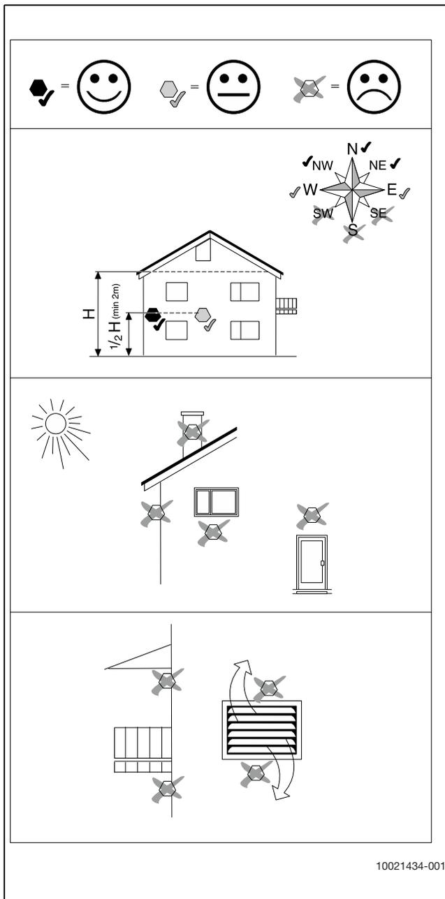
Bild 16 Anordnung des Außentemperaturfühlers
