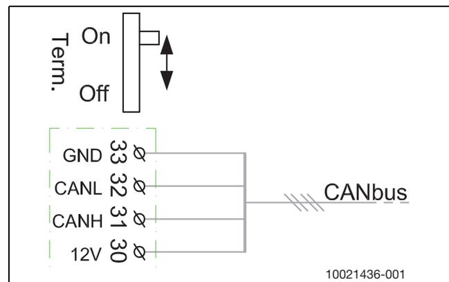
Bild 15 CAN-BUS-Terminierung
