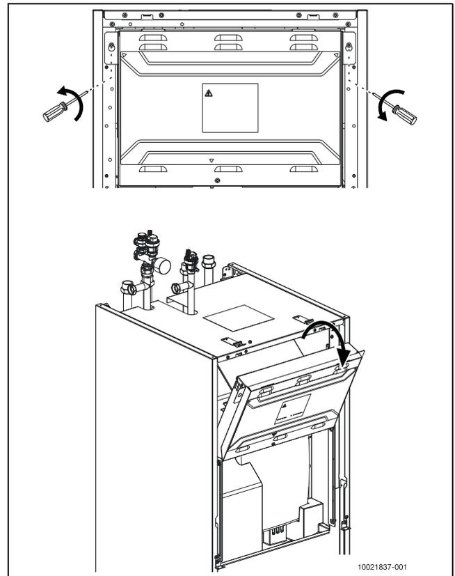
Bild 28 Klemmenkasten
