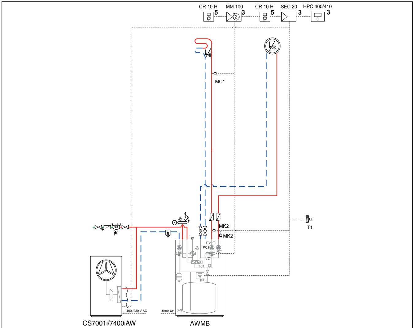
Bild 48 Wärmepumpe, Inneneinheit mit einem gemischten und einem ungemischten Kreis ohne WW
