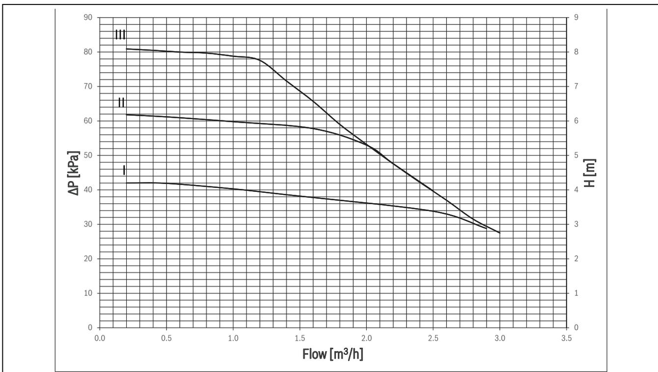
Bild 44 Restförderhöhe Heizkreispumpe für den Anschluss an den ungemischten Heizkreis für PC1 im Betrieb mit konstantem Druck
