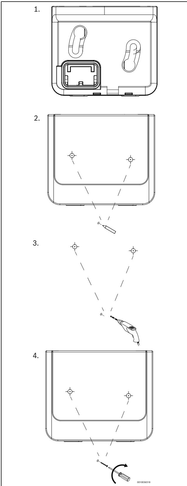
Bild 22 Montage des Halters an der Wand
