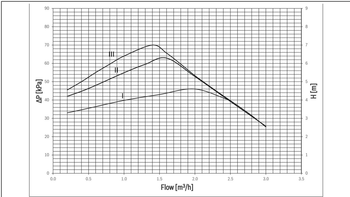
Bild 43 Restförderhöhe Heizkreispumpe für den Anschluss an den ungemischten Heizkreis für PC1 im Betrieb mit proportionalem Druck
