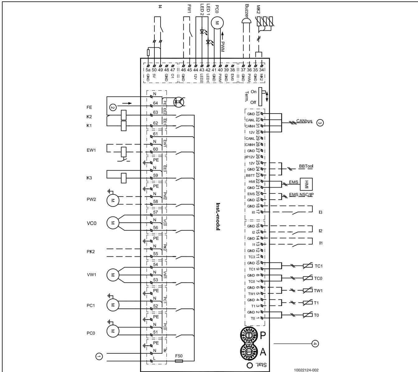
Bild 54 Schaltplan Installationsmodul
