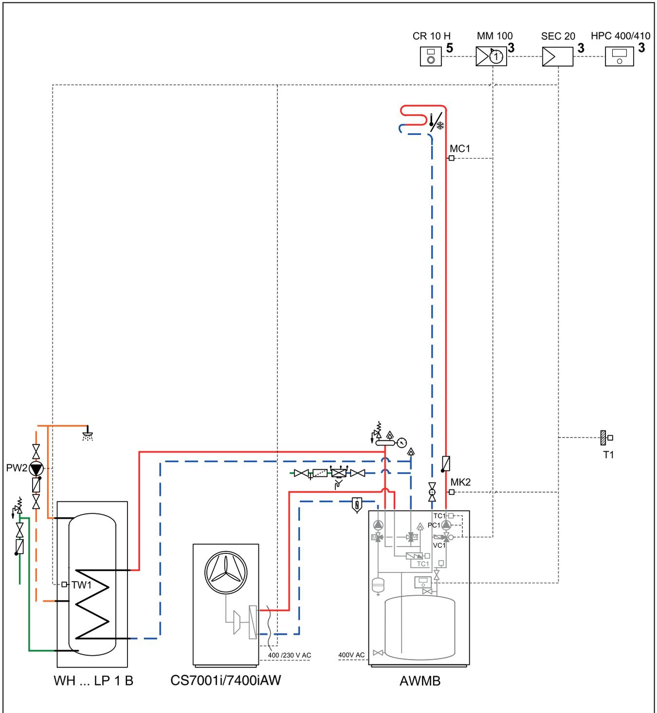
Bild 46 Wärmepumpe, Inneneinheit und gemischter Kreis
