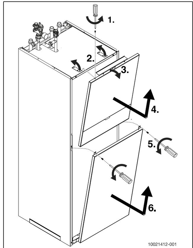
Bild 10 Abdeckungen entfernen
