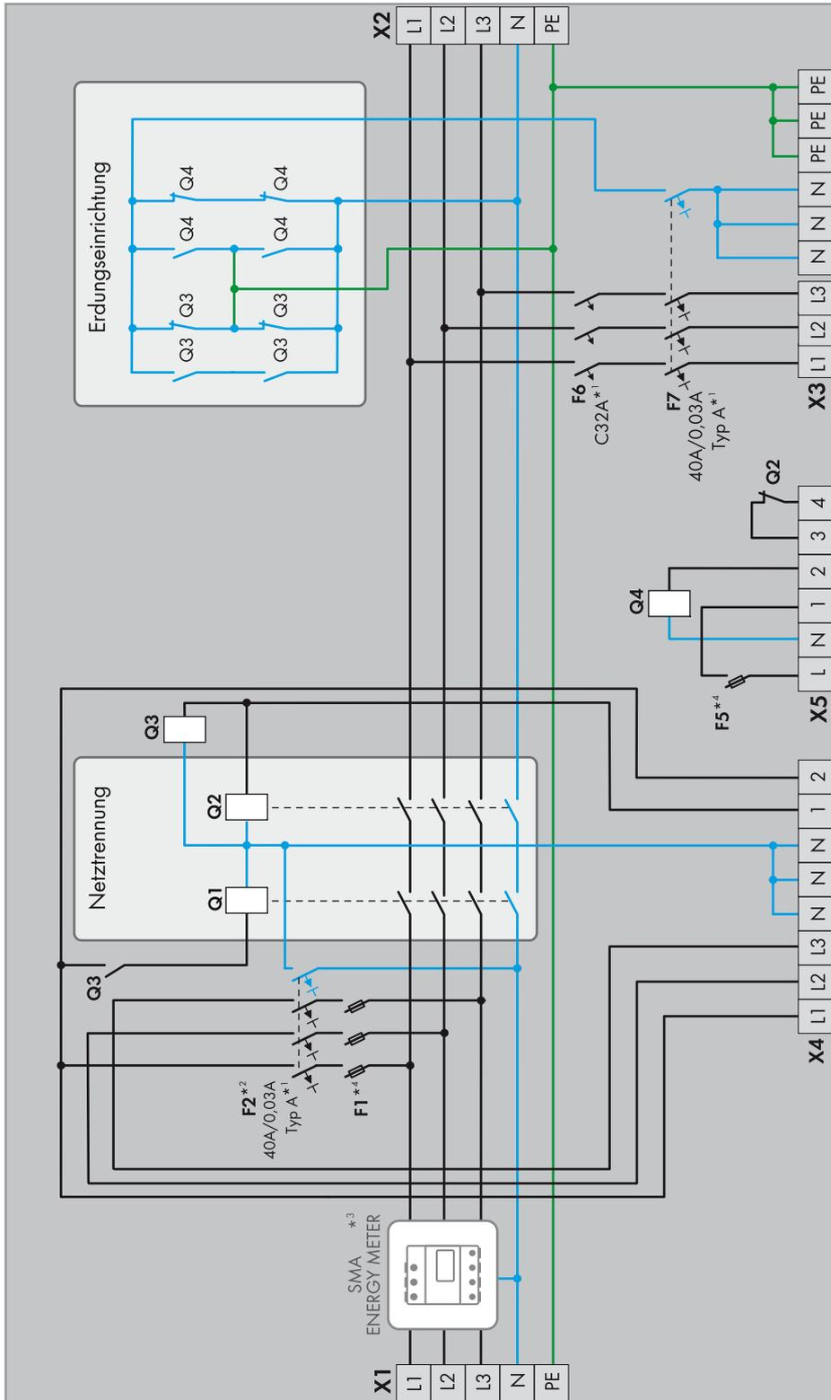
Abbildung 7: Stromlaufplan der 3-phasigen Umschalteneinrichtung mit allpoliger Trennung (z. B. für Deutschland)
