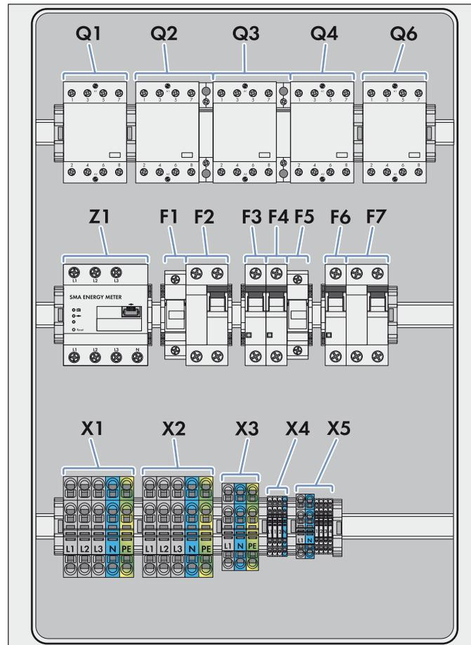
Abbildung 13: Bestückungsvorschlag für 1-phasige Umschalteneinrichtung mit allpoliger Trennung (z. B. für Deutschland)
