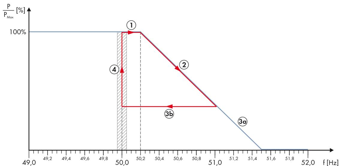
Abbildung 3: Vorschlag zur frequenzabhängigen Wirkleistungsbegrenzung des PV-Wechselrichters (Beispiel)
