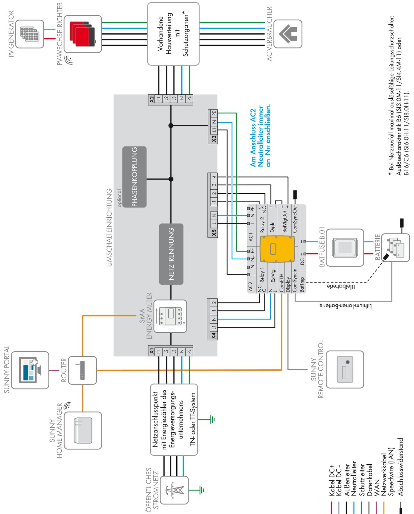
Abbildung 10: Verschaltungsübersicht eines 1-phasigen Ersatzstromsystems ohne allpolige Trennung
