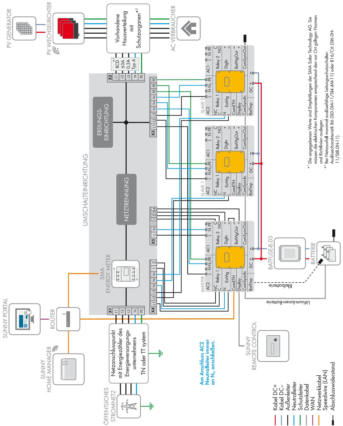
Abbildung 18: Anschluss der 3-phasigen Umschalteinrichtung mit allpoliger Trennung für Belgien
