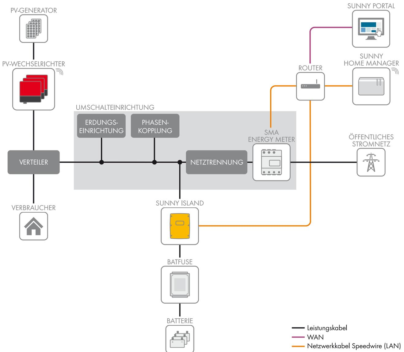
Abbildung 1: Übersicht eines SMA Flexible Storage System mit Ersatzstromfunktion
