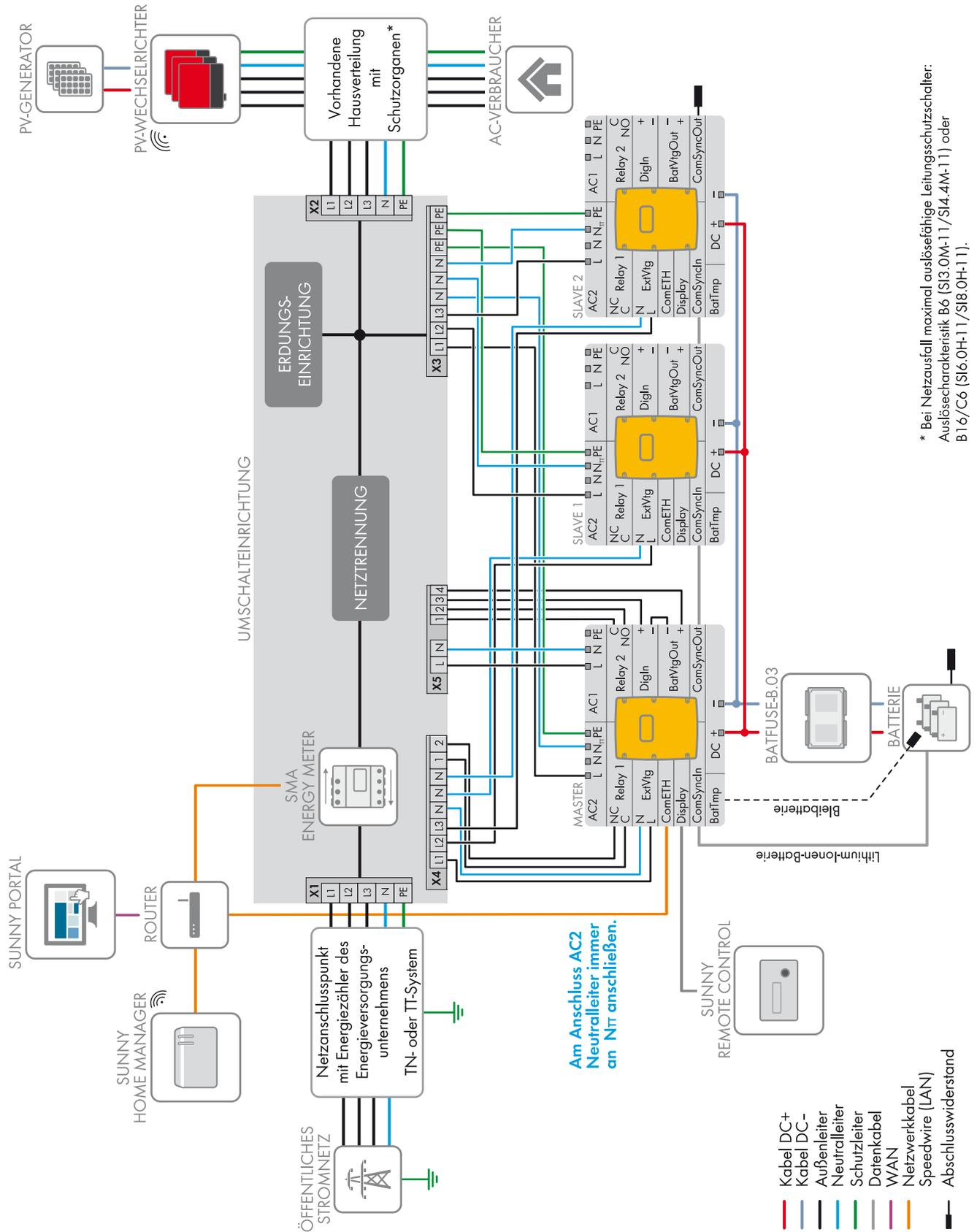
Abbildung 8: Verschaltungsübersicht eines 3-phasigen Ersatzstromsystems mit allpoliger Trennung (z. B. für Deutschland)
