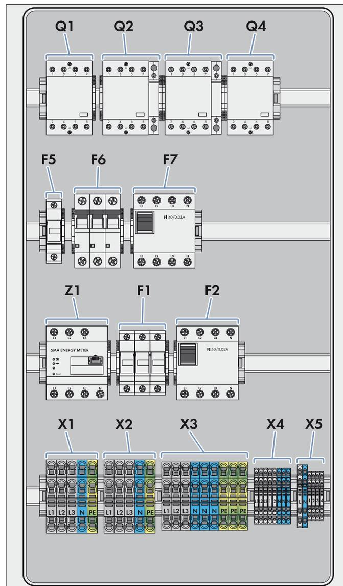
Abbildung 14: Bestückungsvorschlag für 3-phasige Umschalteneinrichtung mit allpoliger Trennung (z. B. für Deutschland)
