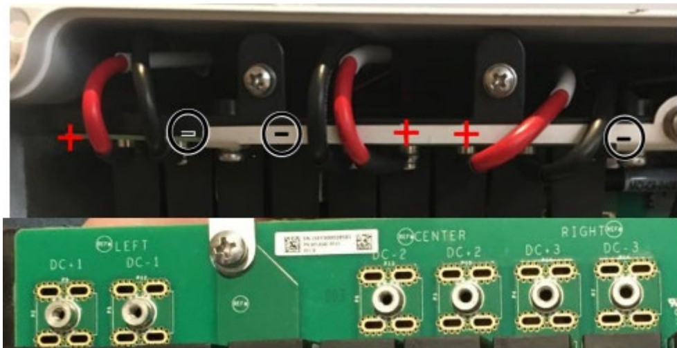
Abbildung 18: Achten Sie auf die richtige Polarität
