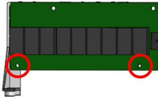
Abbildung 14: Einsetzen der Überspannungsschutzplatine in die Halterung für den DC-Überspannungsschutz
