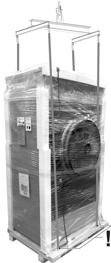
Beispiel: Krananhebung mit Traverse
