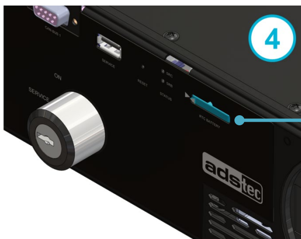
ABBILDUNG 45: PUFFERBATTERIE SRC4310 TAUSCHEN - 4
