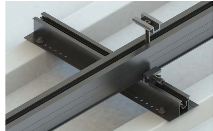
Trapezblechbrücke Plus S (L = 400mm), Kreuzverbinder 2.1, Träger-Profil TP65, Modulklemme
