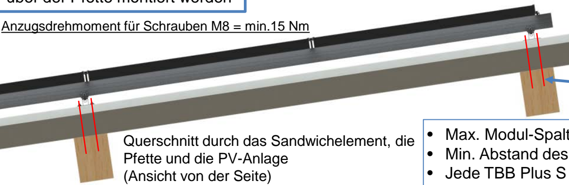
Querschnitt durch das Sandwichelement, die Pfette und die PV-Anlage (Ansicht von der Traufe)
